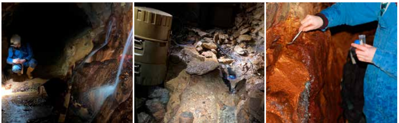
Abb. 2: Messungen untertage. Wartung der Pegelstellen (links), Automatische Probenahme und kontinuierliche UV-Vis Spektrometermessung (Mitte), Probenahme an Tropfstelle während der 2-3- wöchigen Kampagnen (rechts)
