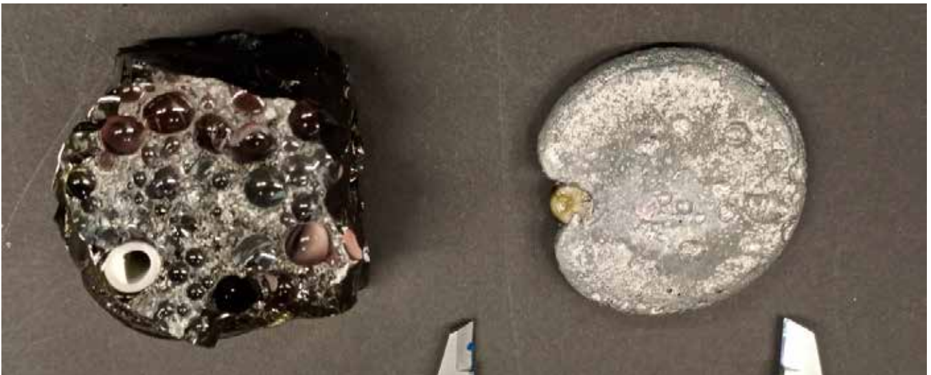
Abb. 3: Die resultierende Schlackephase (links) des Nippon 6 cm Experiments (vgl. Abb. 2) ist von ihrer Zusammensetzung her zur Glaskeramik- und sogar Glasfaserherstellung geeignet, da der FeO-Anteil unter 10 Gew. % fällt. Das führt zu einem günstigen Viskositäts-Temperatur-Verlauf beim Faserzug. Die resultierende Roheisenphase (rechts) ist für die Stahlindustrie nutzbar, wenn durch Mischung mit anderem Material dem erhöhten Kupfergehalt von 1,7 Gew. % Rechnung getragen wird. Etwa 71 Gew. % des insgesamt verfügbaren Eisens sind abgetrennt worden.
