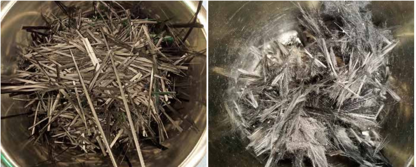
Abb. 2: Nippon KF 6 cm Stücke vor (links) und nach (rechts) dem Reduktionsexperiment (66 g Fasern auf 500 g Schlacke). Etwa 22 g Fasern verbleiben nach dem Experiment; dies entspricht einem Umsatz von X_c=67\% . Die Fasergrößen variieren stark. WHO-Fasern liegen zwar vor, die meisten Fasern sind jedoch noch relativ intakt und wurden vermutlich oberhalb der Schmelze gefangen. Diese Fasern können als Reduktionsmittel im gleichen Prozess neu eingesetzt werden und zeigen dann typischerweise einen noch besseren Umsatz, da sie bereits eine erhöhte Oberfläche aufweisen.
