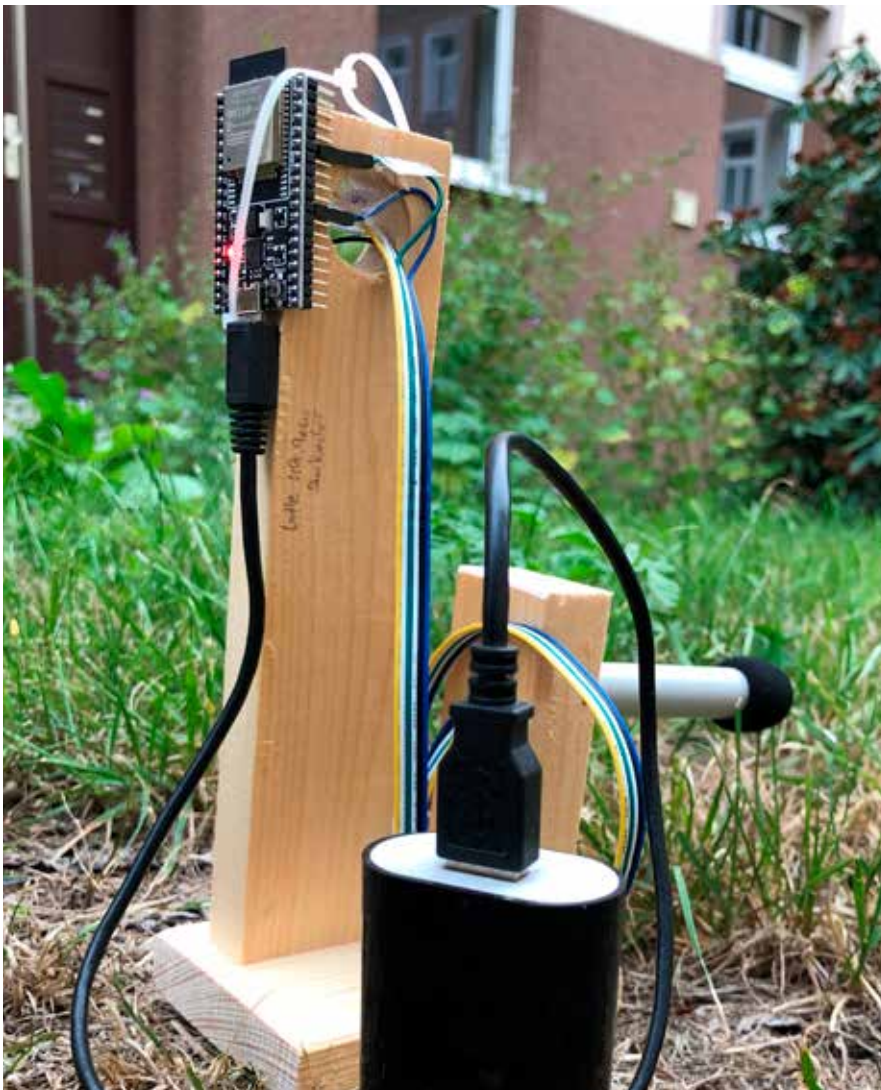
Abb. 1: Autarkes Sensorsystem zur Lärmmessung und drahtlosen Datenübertragung
