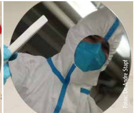
Ergebnis des SprayTex-Prozesses: Polierte Oberfläche eines Halbleiterwafers
