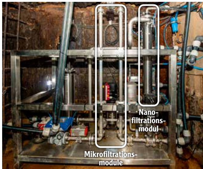
Abb. 7: Hybride untertägige Membranpilotanlage. [R. Kunz]
