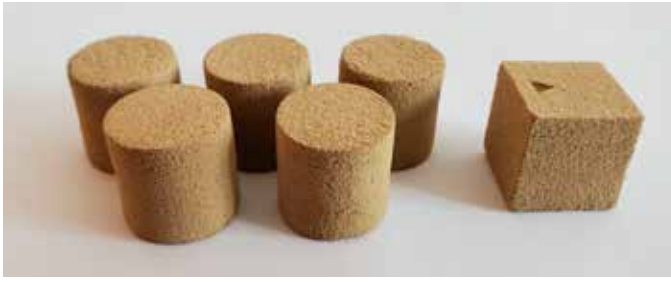
Abb. 4: Mittels Binder Jetting gedruckte Probekörper aus Wasserhyazinthe und 15 Gew.-% PVA
