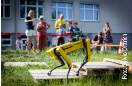
Der Roboter R-EX ist mit modernster Sensorik ausgestattet und wird für die Erkundung in schwer zugänglichem oder für den Menschen gefährlichem Gelände genutzt.
