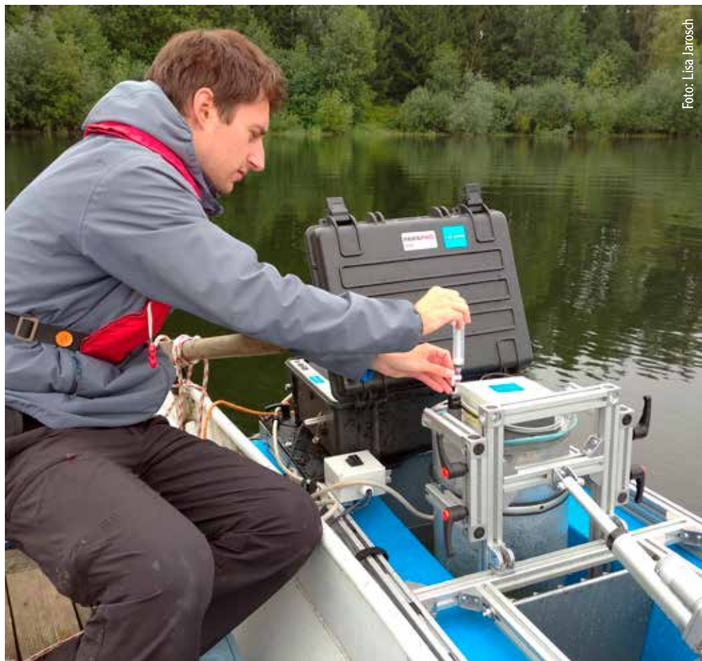
Abb. 3: Betrieb des Kammersystems SEMACH-FG aqua zur Messung von Treibhausgas austausch auf der Talsperre Saldenbach, 24.08.2021
