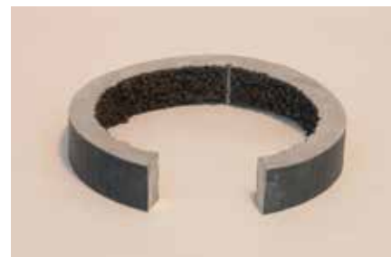
Rohr mit Hochtemperaturkorrosion
