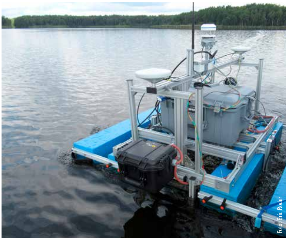
Abb. 1: Plattform mit Nutzlast Echolot (Sonar) und Doppelrumpfen bei Messungen auf dem Speicherbecken Lohsa I, 03.08.2021
