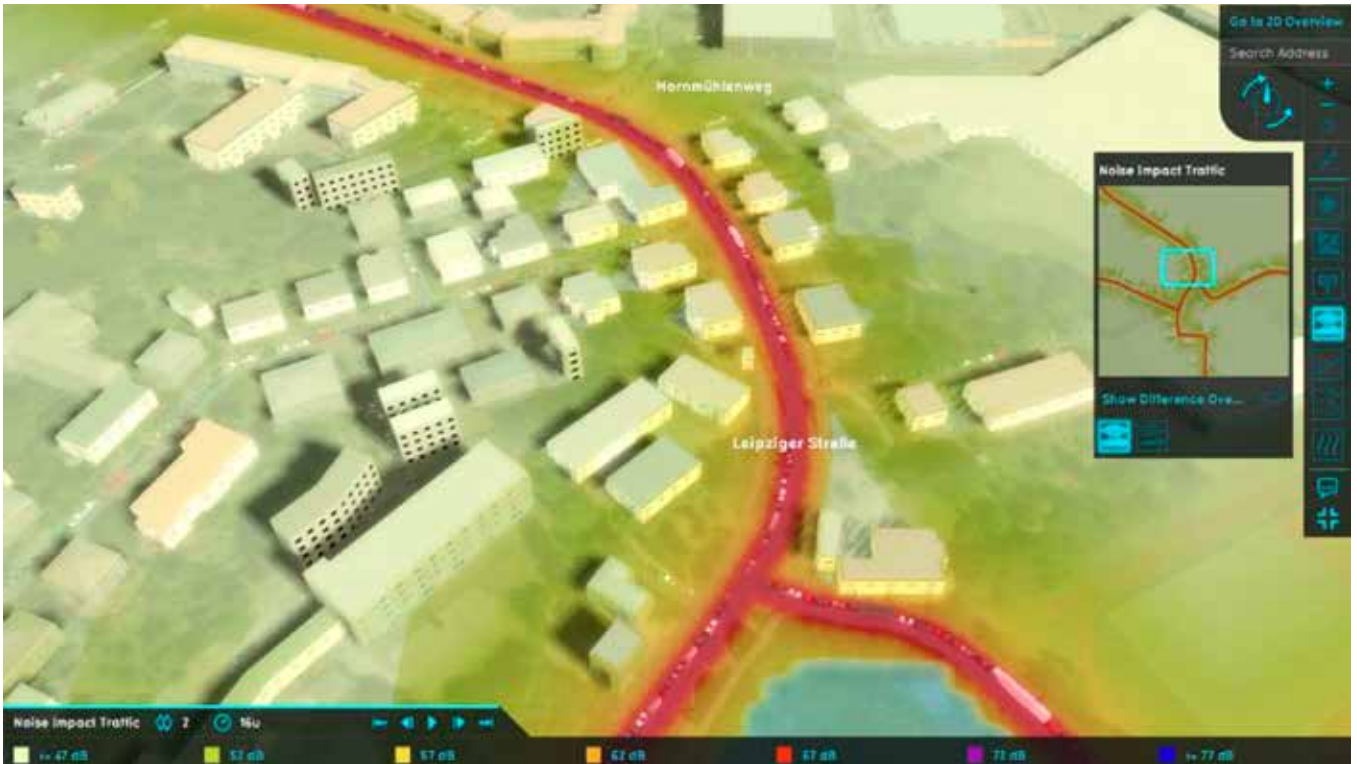
Abb. 2: Lärmmodellierung für die Leipziger Straße in Freiberg mit der Plattform Tygron LTS. Tygron LTS ist eine online High Performance Computing GIS-Anwendung, welche basierend auf offenen Geodaten verschiedene 3D-Berechnungen anbietet. Darunter befindet sich auch ein Modell für die Lärmemissionsberechnung nach dem niederländischen Standardberechnungsverfahren (Berechnungs- und Messvorschriften für Lärm 2012, Regelung van de Staatssecretaris van Infrastructuur en Milieu, van 12 juni 2012, nr. IENM/BSK-2012/37333, https://wetten.overheid.nl/BWBR0031722/2015-07-01 Zugriff: 14.09.2022).
