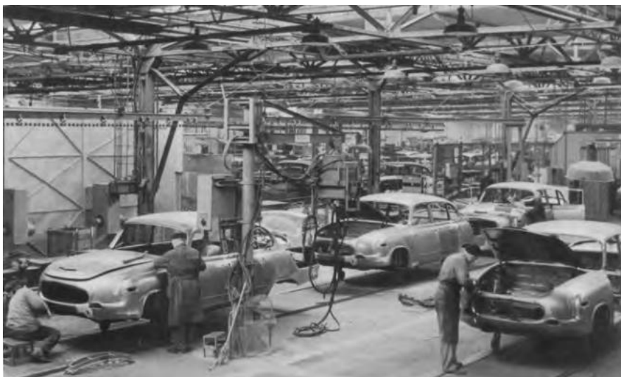
Abb. 5: Ansicht der handwerklichen Fertigung von Tatra 603 Karosserien im mährischen Kopřivnice aus dem Jahr 1962. (Foto: Privatsammlung Malte Krüger)
