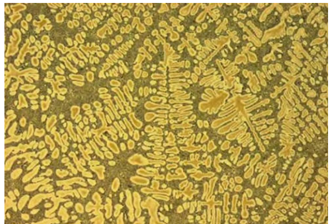
Abb. 8: Lichtmikroskopische Gefügeabbildung einer klassischen untereutektischen Al-Si-Legierung, die das dendritische Wachstum des Aluminiummischkristalls aus der Schmelze zeigt und das feine eutektische Gefüge der erstarrten Restschmelze.
