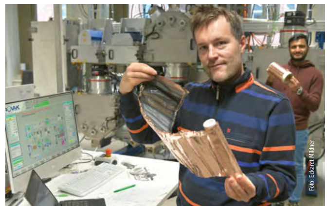
Dr. Hartmut Stöcker von der Bergakademie mit einer Silizium-auf-Kupfer-Rolle. Das Material dient zur Produktion von Anoden für leistungsfähigere Lithiumbatterien.
