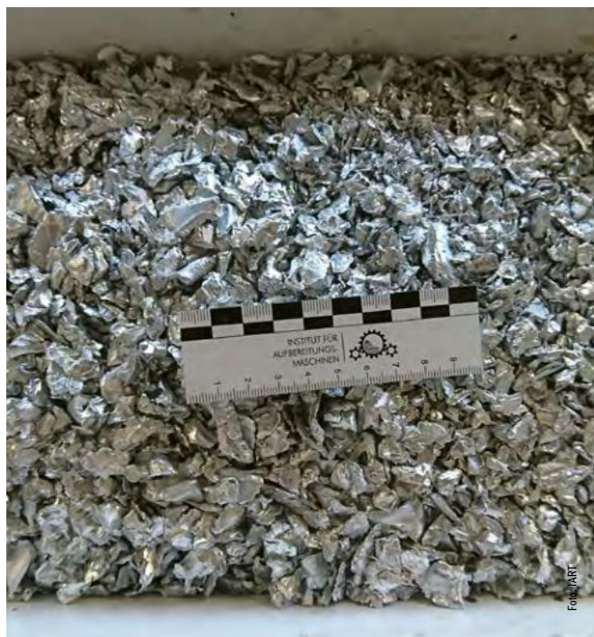
Abb. 5: Aufbereiteter Aluminiumschrott bzw. Aluminiumrezyklat in definierter Partikelgröße und -form
