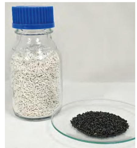
Abb. 3: Extrudierter Katalysator vor (links) und nach der Olefin-Oligomerisierung (rechts)
