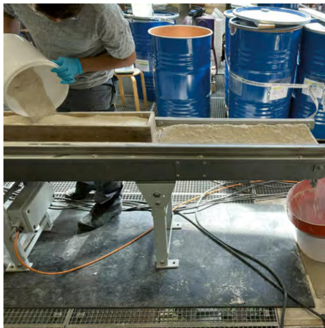
Abb. 2: Aufgabe des Lithium-haltigen Rohmaterials auf das Förderband
