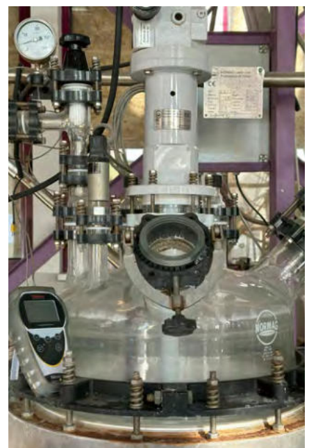
Abb. 8: Kühlungskristallisation in der Aufreinigungsphase des finalen Endprodukts Lithiumhydroxid
