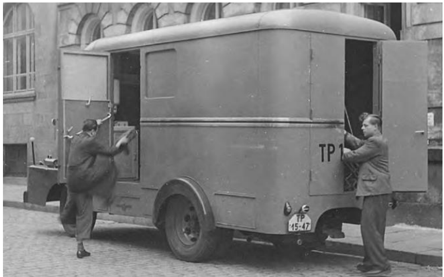
Abb. 3: Der sog. Röntgenwagen aus rückwärtiger Perspektive. Gut zu erkennen sind die Peilstäbe auf dem vorderen Kotflügel, die Zwillingssbereifung auf der Hinterachse und der recht hohe Einstieg in den Kofferaufbau. (Foto aus dem Nachlass von Frau Brunhilde Freyer im Bestand des Medienzentrums der TU Bergakademie Freiberg)
