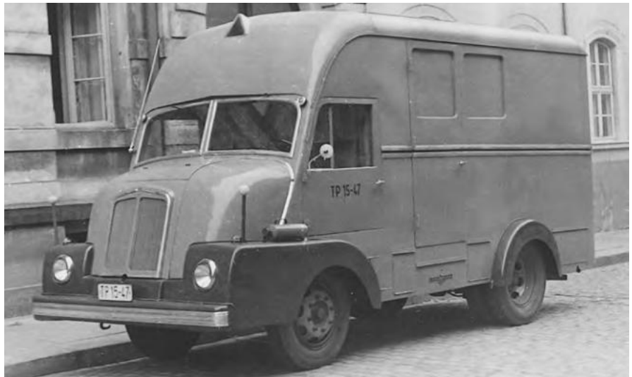
Abb. 2: Der sog. Röntgenwagen, aufgenommen im August 1955 in der Prüferstr. vor dem heutigen Eingang zum Medienzentrum. Fahrzeug mit nach dem 2. Weltkrieg individuell angefertigter Sonderkarosserie, vermutlich auf einem 1,5 t Steyr 1500 Chassis um 1944. Das mit „TP“ beginnende Kennzeichen verweist auf den vormaligen Kreis Oelsnitz im Bezirk Karl-Marx-Stadt der DDR. (Foto aus dem Nachlass von Frau Brunhilde Freyer im Bestand des Medienzentrums der TU Bergakademie Freiberg)
