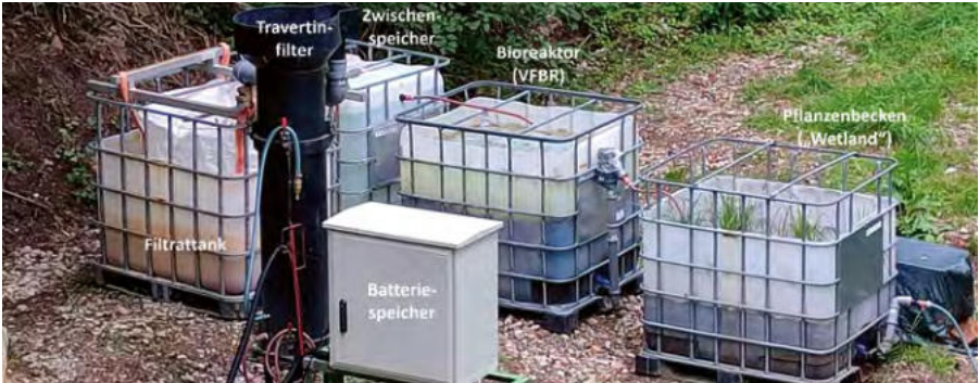
Abb. 4: Aufbau der Pilotanlage: PV-Module und Speicher-IBC (links) sowie Verfahrensstufen Travertinfilter, Zwischenspeicher, Vertical Flow Bioreaktor (VFBR) und Pflanzenbecken (rechts) (Fotos: E. Janneck)
