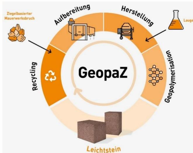
Die Herstellung erfolgt durch Anrühren einer Dreikomponentenmischung bestehend aus ziegelbasierten Reststoffen, einer wässrigen alkalischen Lösung sowie eines sekundärrohstoffbasierten Treibmittels. Die chemisch-thermische Aktivierung erfolgt bei Temperaturen im Bereich von 60-100 °C.
