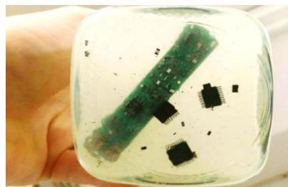
Das Verfahren *Bio-dismantling* löst elektronische Bauteile mithilfe einer Bakterienlauge von Leiterplatten. Die Bakterien korrodieren
