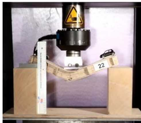
Siegerbrücke im 3-Punkt-Biegetest während der Belastung
