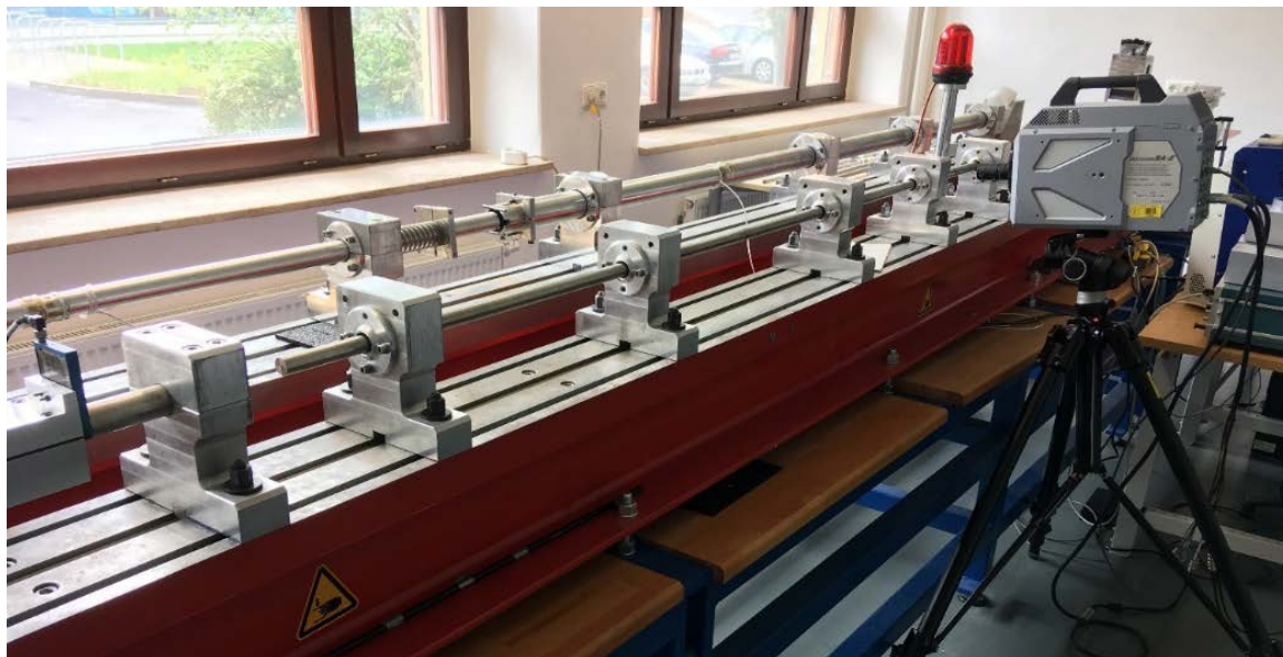
Split Hopkinson Pressure Bar Versuchsstände mit Hochgeschwindigkeitskamera
