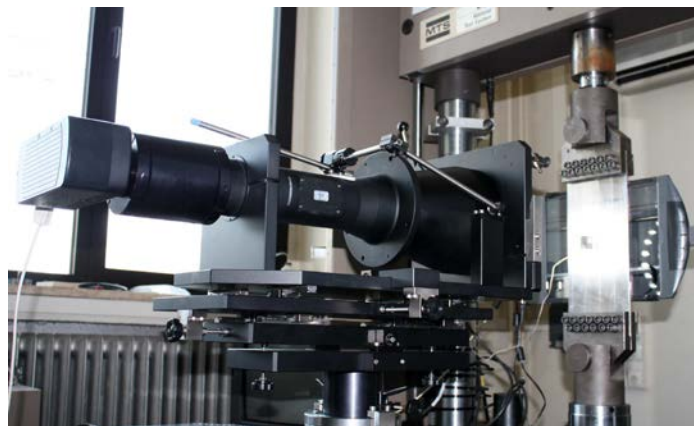
Risswachstumsprobe mit optischen Messsystemen zur Risslängenerfassung
