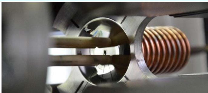
Biaxiale LCF-Probe mit Feindehnungsaufnehmer, Thermoelement und Induktionsspule
