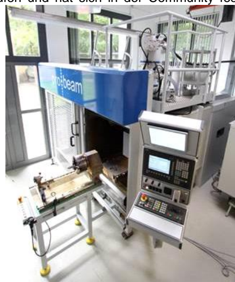
Elektronenstrahl-Universalanlage K26-80/15 (seit 2008)
