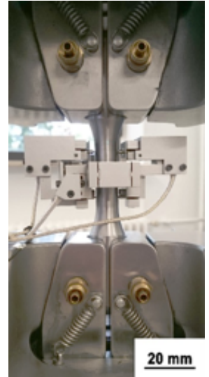
Abb. 2: Eingebaute Probe mit angesetztem Axial-Torsional-Dehnungsaufnehmer
