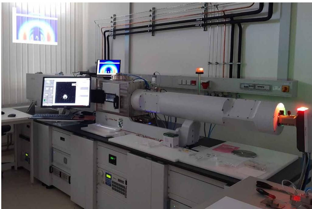
**Röntgenkleinwinkelstreuanlage mit Hochtemperaturkammer**
