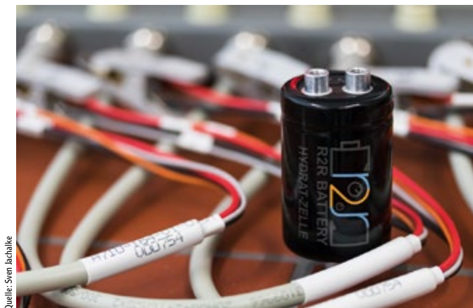
Abb. 1: Auf Aluminium basierende Feststoff-Batterie nach der Fertigung Rolle-zu-Rolle
