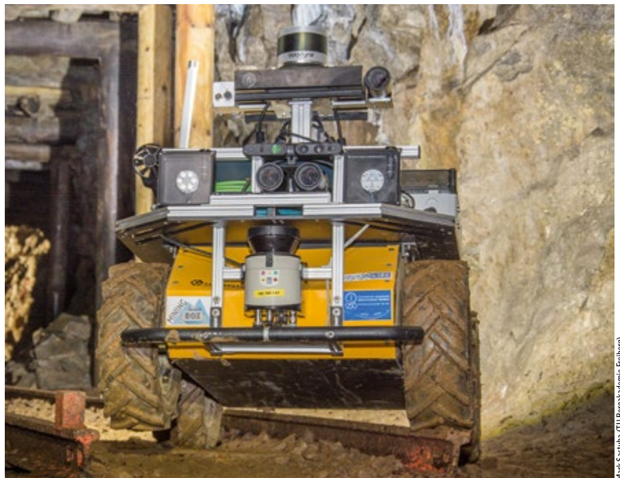
Abb. 1: Mit dem Projekt Mining-RoX entstand der Forschungsroboter „Alex“. Dieser erkundet das hiesige Forschungs- und Lehrbergwerk und liefert dabei Daten für die detailgetreue 3D-Rekonstruktion.
