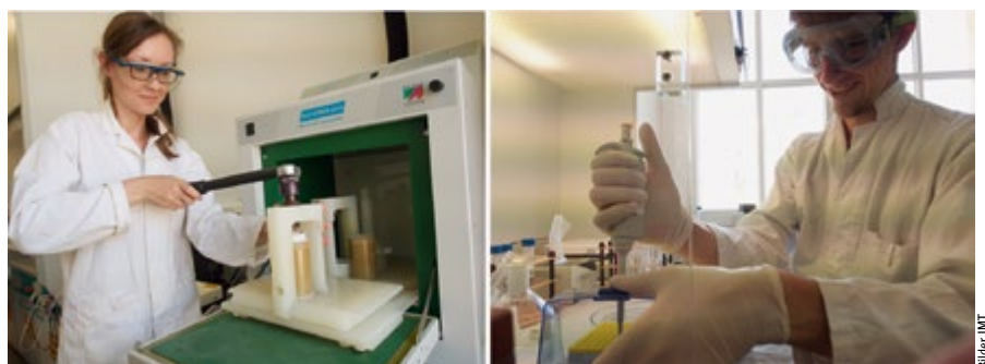
Abbildung 2: Spurenelement-Analytik-Praktikum mit Susanne Meichsner (l.) an einem Mikrowellenaufschlussgerät sowie Manuel Diercks (r.) beim Pipettieren einer Probenvorbereitungslösung
