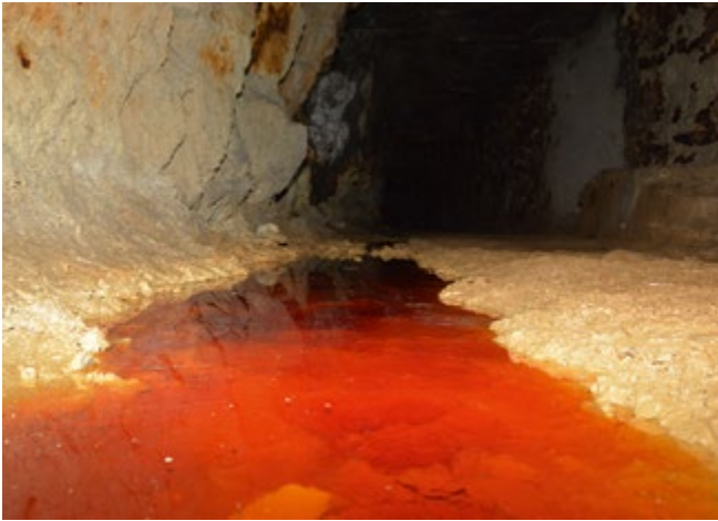
Abbildung 1: Beispiel eines Austritts von sauren Bergbauwässern (links) mit einem pH-Wert von 2,6 bei der Begehung des Wilhelm Stehend Süd in der Reichen Zeche (rechts) [5]
