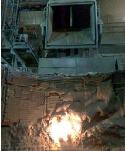
Abb. 4: EFSOP-Proberohr zentrisch zum Abgasvolumenstrom
