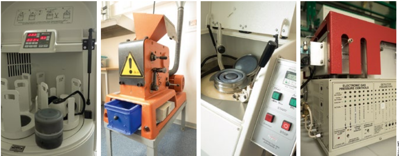
Abbildung 3 – v.l.: Proben zerkleinern und homogenisieren (Mühle, Brecher und Scheibenschwingmühle, Fa. Fritsch) sowie Gaschromatograph (SRI Instruments)
