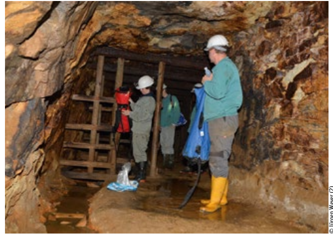
Abbildung 1: Beispiel eines Austritts von sauren Bergbauwässern (links) mit einem pH-Wert von 2,6 bei der Begehung des Wilhelm Stehend Süd in der Reichen Zeche (rechts) [5]
