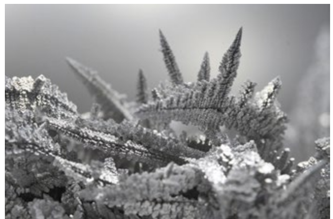
Abb. 4: Indium-Dendriten nach der Elektrolyse
