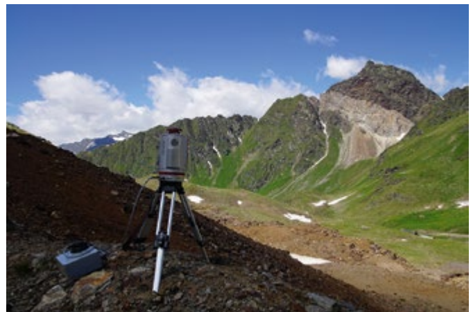
Aufnahme der Umgebung des Tagebaustollens mittels Laserscanning
