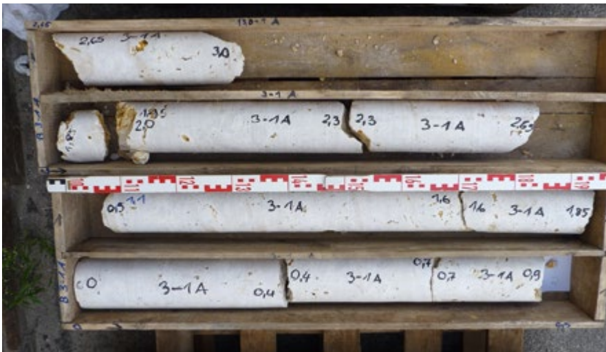
Abb. 6: Dichtkörper nach einer Injektion von Feinstzement in Sand
