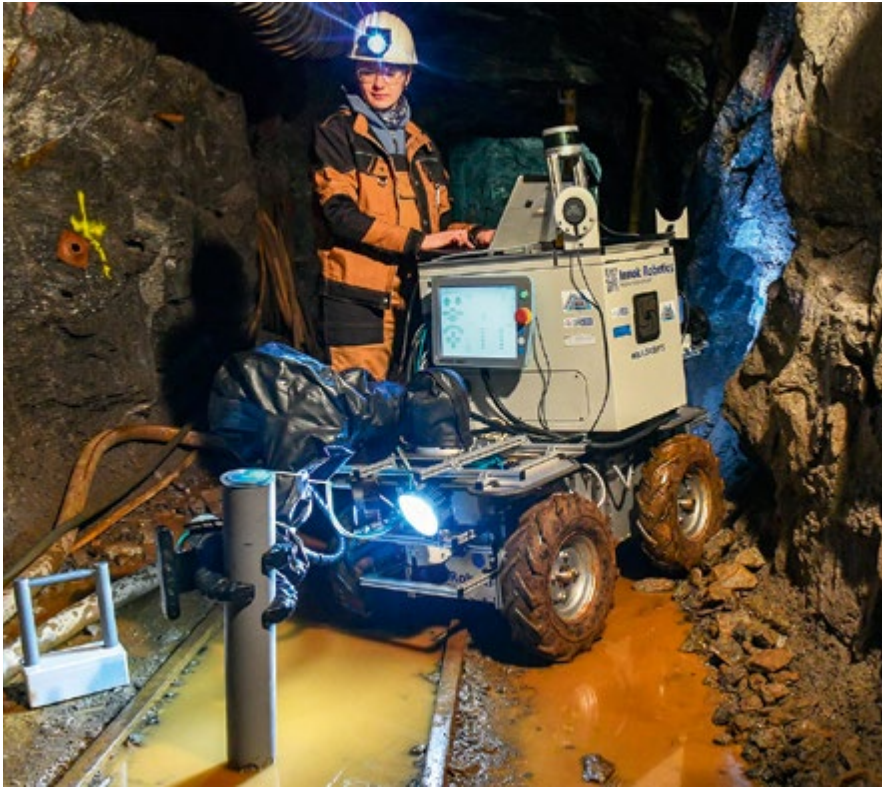
Abb. 2: Julius verfügt über einen Greifarm samt 3-Finger-Hand, was die Handhabung verschiedener Geräte ermöglicht, wie zum Beispiel das Absetzen mitgebrachter Sensorboxen oder einer Wasserprobenentnahmestation.
