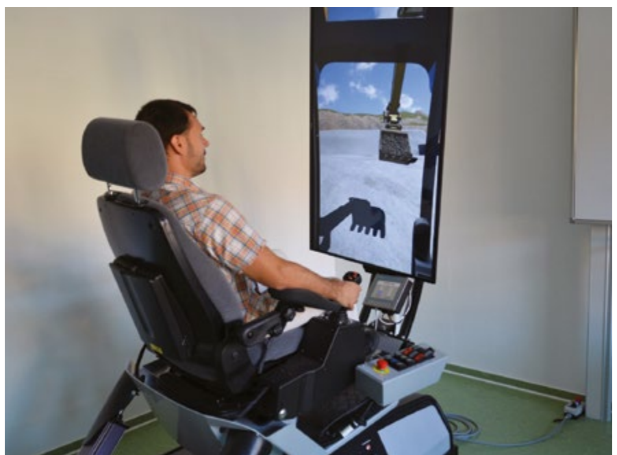
Abb. 3: Bedienung des Hydraulikbaggers mit realen Steuerelementen auf einem dynamischen Träger zum Erleben und Testen der Maschine unter gegebenen Einsatzbedingungen
