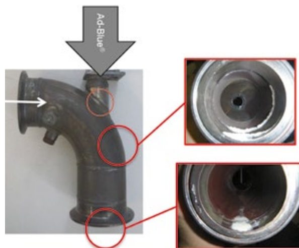
Abb. 3: Darstellung der Ausgangskonfiguration mit Markierung der experimentell gefundenen Feststoff-Ablagerungsstellen (rote Linien)
