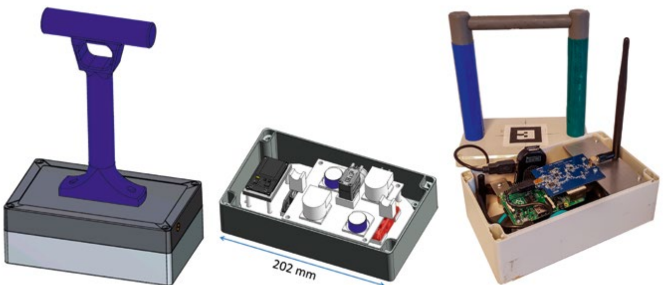
Abb. 5: Von links nach rechts sind verschiedene Stufen der Sensorboxentwicklung zu sehen. Neben dem Innenleben spielen auch die Geometrie und insbesondere der Griff eine wichtige Rolle. Das ARIDuA-Projekt evaluiert verschiedene Varianten. Zwei Kandidaten sind hier zu sehen. In der mittleren Abbildung sind die einzelnen Funktionseinheiten Elektronik- und Kommunikationsmodul (schwarz), Sensoren (blau) und Energieversorgung (rot) exemplarisch hervorgehoben.
