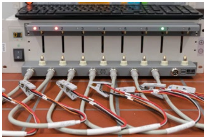
Abb. 2: Auf Aluminium basierende Knopfzellen-Batterien im Teststand
