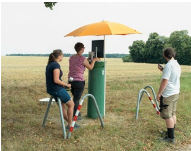
Messung in allen Kombinationen (8 Pfeiler auf 1100 m verteilt) auf der Kalibrierstrecke bei Ganzkow
