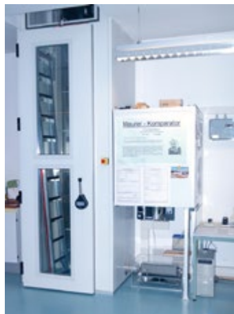
Vergleich – Automatische Prüfung im Komparator nach Prof. Maurer und klassische Lattenprüfung
