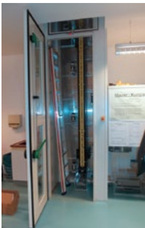
Vergleich – Automatische Prüfung im Komparator nach Prof. Maurer und klassische Lattenprüfung
