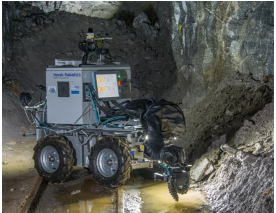
Bild 3: Bergbau-Roboter Julius nimmt eine Bergbauwasserprobe für die pH-Messung im Forschungs- und Lehrbergwerk Reiche Zeche der TU Bergakademie Freiberg
