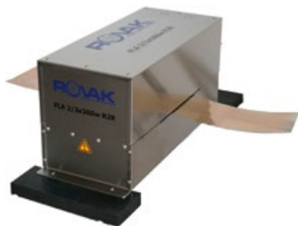
Abb. 2b: Eine kommerziell erhältliche FLA-Anlage der Partnerfirma ROVAK, die für die Integration in bestehende Systeme zur Realisierung von Entwicklungsapplikationen sowie von Produktionsprozessen, z. B. Rolle-zu-Rolle, genutzt werden kann.
