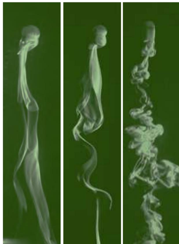
Abb. 3: Nachlaufströmungen hinter aufsteigenden Kugeln; von links nach rechts nimmt die Aufstiegs- und Abfallgeschwindigkeit der Kugeln zu. Die Nachlaufströmungen sind durch einen speziellen Farbstoff sichtbar gemacht, der sich von der Kugelunterseite löst (Aufnahmen für Darstellbarkeit im Artikel nachträglich umgefärbt).
