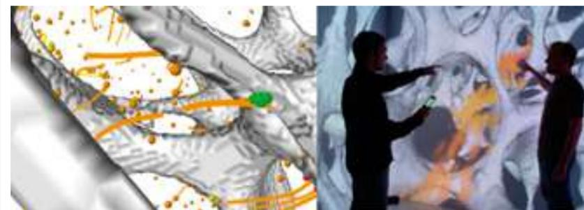
Abb. 5: Links: Partikel in XVis-Framework; Partikel mit Agglomeration, simuliert mit stochastischem Modell innerhalb instationärem Strömungsfeld und echter Filtergeometrie; Anzeige von Bahnlinien, Farbe ist Größe der Agglomerate: rot = abgelagert und Agglomerat der Größe 1 (orange), 2 (gelb), 3 (grün); Rechts: Visualisierung der Filtrationsprozesse in der CAVE am Institut für Informatik
