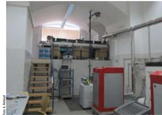
Abb. 1: Die beiden roten „Kirsch“-MBHKW mit zwei 500L-Pufferspeichern auf der unteren Raumebene des VK-Labors, dahinter der Motorprüfstand (ehemaliger Heizungsraum im Nordflügel des Gebäudes Lessingstraße 42). Blick auf die obere Raumebene des Labors mit Prozessleitstand und Batteriespeicher (blau oben links)
