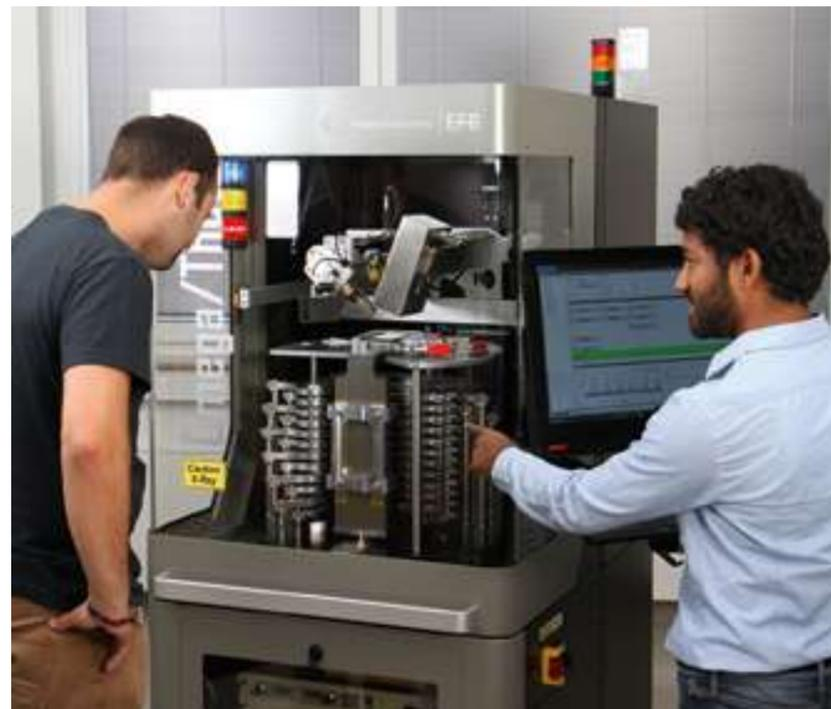
Omega/Theta-Diffraktometer: Halbleitermesstechnik zur industriemäßigen Orientierung von Einkristallen
