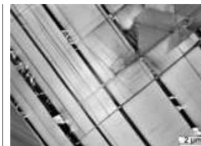
Abb. 17: Invertierte ECCI (Electron Channeling Contrast Image)-Aufnahme des verformten CrMnNi-Stahls 16-7-3: einzelne Stapelfehler, Deformationsbänder und  $\alpha'$ -Martensitkeime an Schnittpunkten und im Inneren der Bänder
