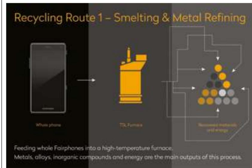
Abb. 5: Recyclingweg 1 – Einschmelzen ohne vorheriges Trennen (einfache Ansicht). Er sieht das Einschmelzen der unzerlegten Mobiltelefone in einem Hochtemperaturschmelzofen vor. Auch auf diesem Weg lassen sich Metalle, Legierungen, anorganische Verbindungen sowie Energie zurückgewinnen.
