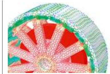
Abb. 8: 3D-Verteilung der magnetischen Flussdichte in einer Transversalflussmaschine
