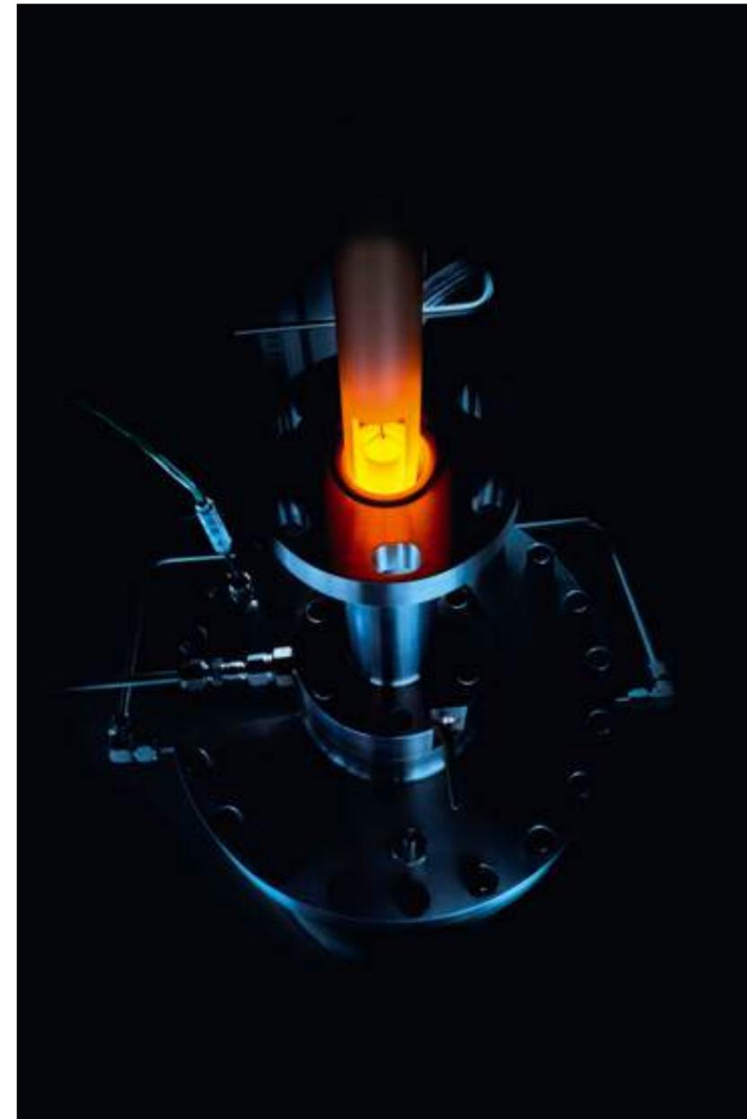
Abb. 3: Messung von Sorption bei 1000 °C (Messzelle geöffnet)
