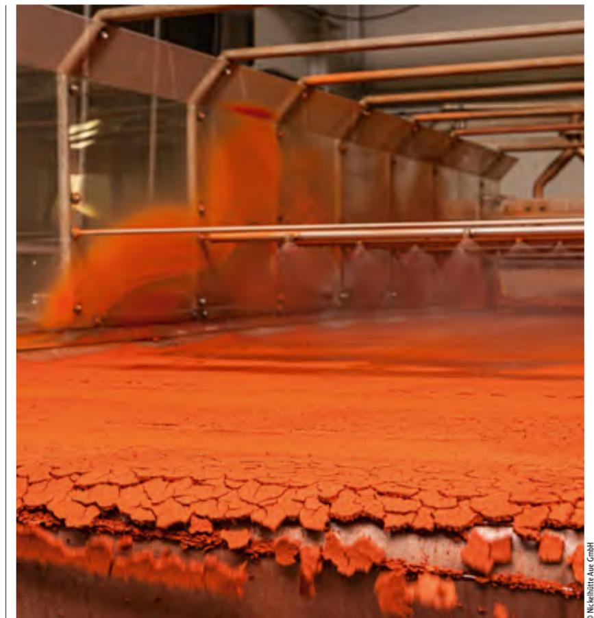
Abb. 6: Waschen und Filtern des Vanadiumpentoxids
