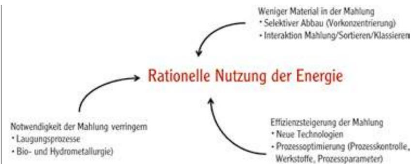
Abb. 3: Ansatzpunkte zur Steigerung der Energieeffizienz bei der Zerkleinerung (schematisch nach MIFU Report 11/2010 [5]).
