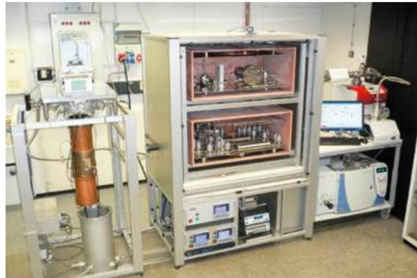
Abb. 2: Neu entwickelte Kalibrieranlage für Stoffdatensensoren bis 200 bar bei 200 °C
