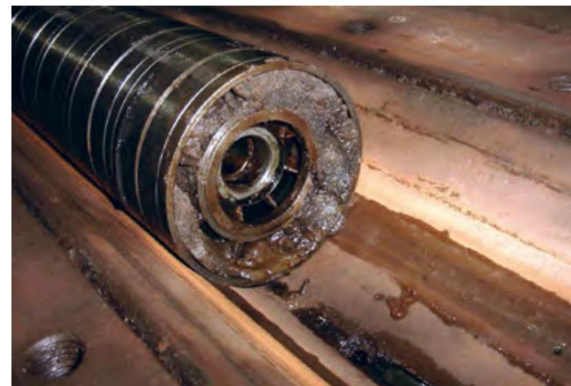
Abb. 3: Versandete Tauchkreiselpumpe nach Versagen eines Sandfilters [1]
