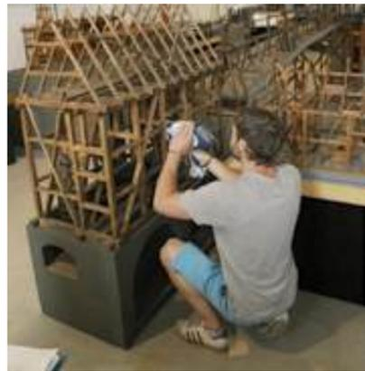
Holzschutzmittelscreening am Modell „Feldgestänge“ mit einer pRFA durch Marco Herrmann
