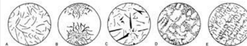
Abb. 1: Richtreihe für die Grafitanordnung bei GJL nach DIN EN ISO 945 [1]
