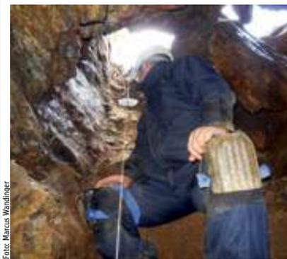
Messung des Kompasszuges im Übergang vom übertägigen zum untertägigen Bereich
