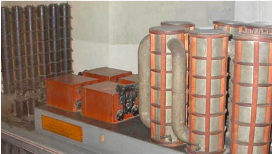
Da von der Kontaktanlage in Muldenhütten nichts erhalten blieb, ist ein originalgetreues Modell derselben, das sich in der Sammlung hüttenmännischer Modelle der TU Freiberg befindet, als ein umso wertvolleres Zeugnis der Industriegeschichte zu bewerten. V. r.: Filtertürme zur Röstgasentstaubung, je zwei Vorwärm- und Kontaktöfen mit fünf Röhren, anschließend drei doppelte Absorptionstürme. Der Aufbau entspricht der Anlage, wie sie seit 1882 bestand. Maßstab 1:25
