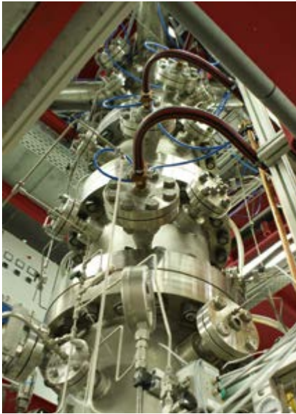
Abb. 4: (links) KIVAN-Reaktor zur Bestimmung von Hochdruck-Reaktionskinetiken; (rechts) Viskosimeter
