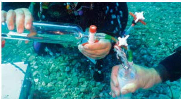
Abb. 5: Gasprobenahme unter Wasser nach der Giggenbach-Methode
