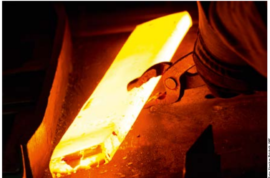
Abb. 3: Warmwalzversuch an der Konti-Warmwalzstraße des Instituts für Metallformung
