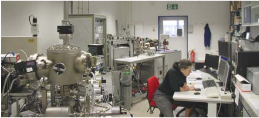
Abb. 4: „Garagenfirmenatmosphäre“ im Ar-Ar-Labor. Linker Vordergrund: Probentransfersystem für hochpräzise thermische Entgasungsexperimente und bewegliches thermisches (CO 2 -)Lasersystem, gekoppelt an ein Gasreinigungssystem und ein ARGUS Multikollektor-Gasmassenspektrometer. Hintergrund: Ar-F-Laserablationssystem, gekoppelt an ein Gasreinigungssystem und ein ARGUS VI Multikollektor-Gasmassenspektrometer mit Faraday- und Elektronenvervielfacher-Detektorsystem.
