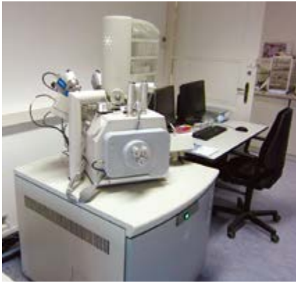
Abb. 3: Rasterelektronenmikroskop FEI Quanta 650FEG-MLA – Geometallurgie-Labor der Professur für Lagerstättenlehre und Petrologie, Institut für Mineralogie der TU Bergakademie Freiberg
