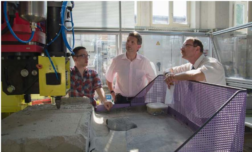
Abb. 11: Technikums-Schneidversuchsstand für Böden und Gestein zur Optimierung des Schneidprozesses
