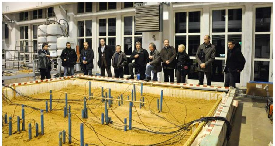
Abb. 10: Großversuchsstand zur Untersuchung von HDD (Horizontal-Directional-Drilling)-Brunnen
