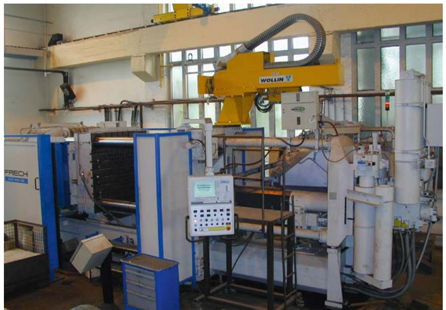
Abb. 18: Druckgießmaschine
