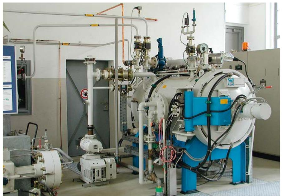
Abb. 16: Vakuum-Wärmebehandlungsanlage mit Hochdruck-Gasabschreckung
