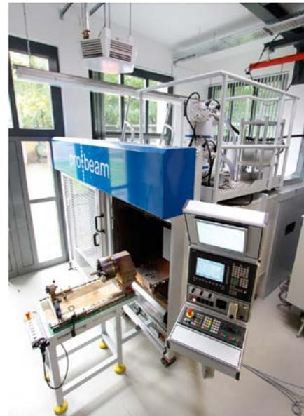
Abb. 34: Universal-Elektronenstrahl-Anlage
