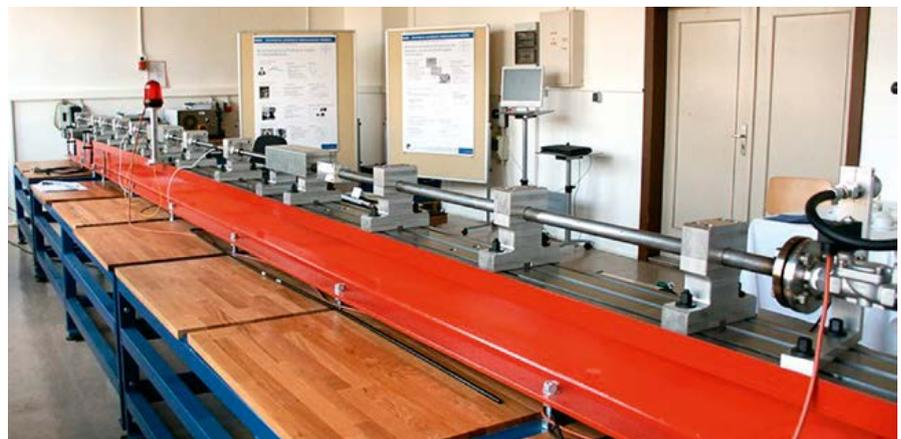
Abb. 32: Split-Hopkinson-Pressure-Bar für hochdynamische Druckversuche
