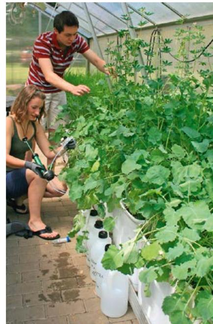
Abb. 19: Entnahme von Bodenlösung im PhytoGerm-Gewächshausversuch mit Raps als zu testendem Germaniumakkumulant
