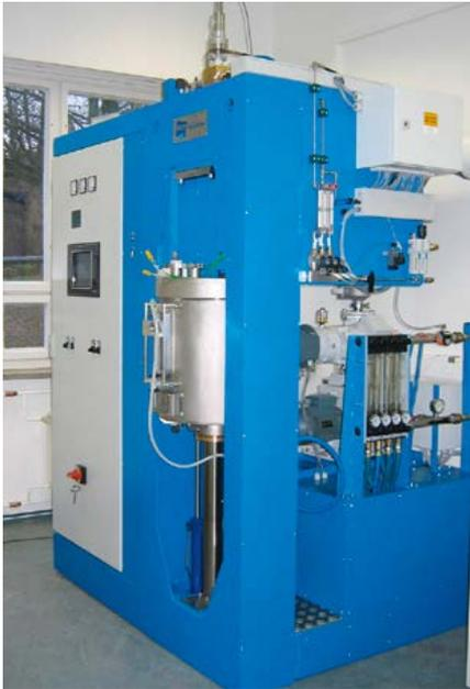
Abb. 27: SPS-Anlage FCT HP D 25/2
