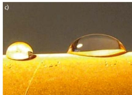
a) Faserstrukturierter Dämmstoff, b) Numerische Simulation einer Drallströmung, c) Kondensierte Wassertropfen auf einer Polymeroberfläche
