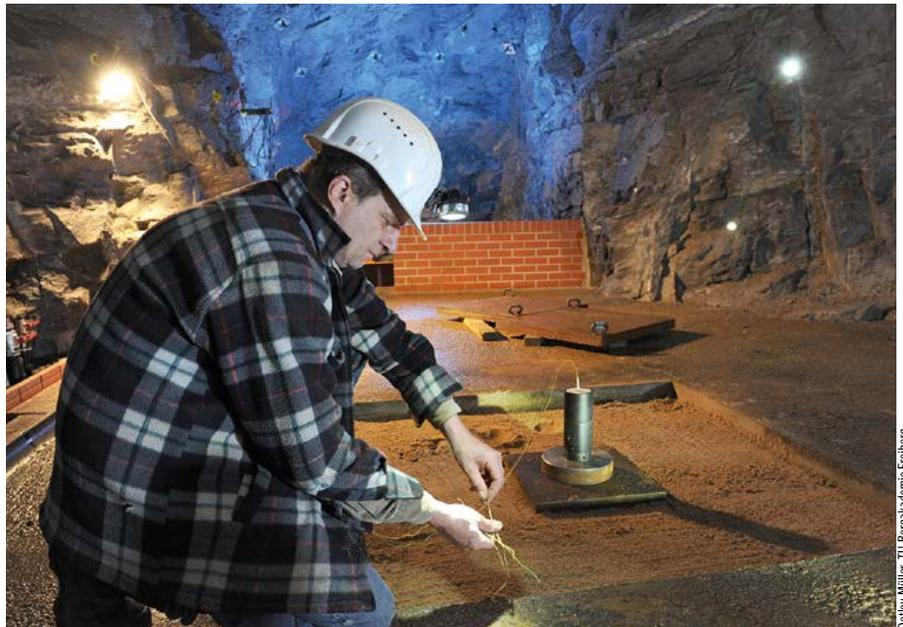
Abb. 6: Versuchsaufbau für Flyer-plate-Schockwellenversuche im Freiburger Schockwellenlabor im Forschungs- und Lehrbergwerk »Reiche Zeche«
