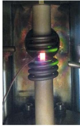
Bild 24: Prüfchamber der Umformsimulatoren Gleeble HDS-V40 (links) und der Bähr MDS 830 (rechts)
