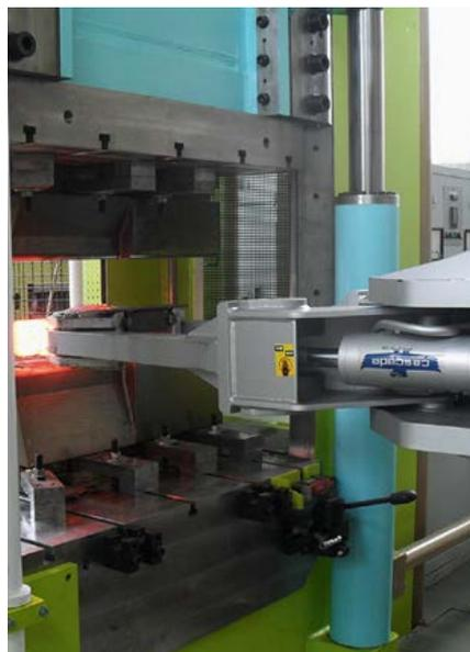
Abb. 22: 10-MN-ölydraulische Universalumformpresse (links), unter anderem mit der Möglichkeit des Freiformschmiedens (rechts)
