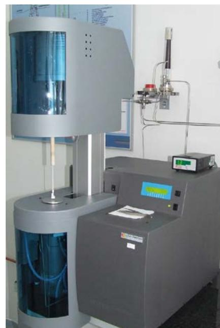
Abb. 31: Differenzthermoanalysegerät SETARAM Setsys Evolution
