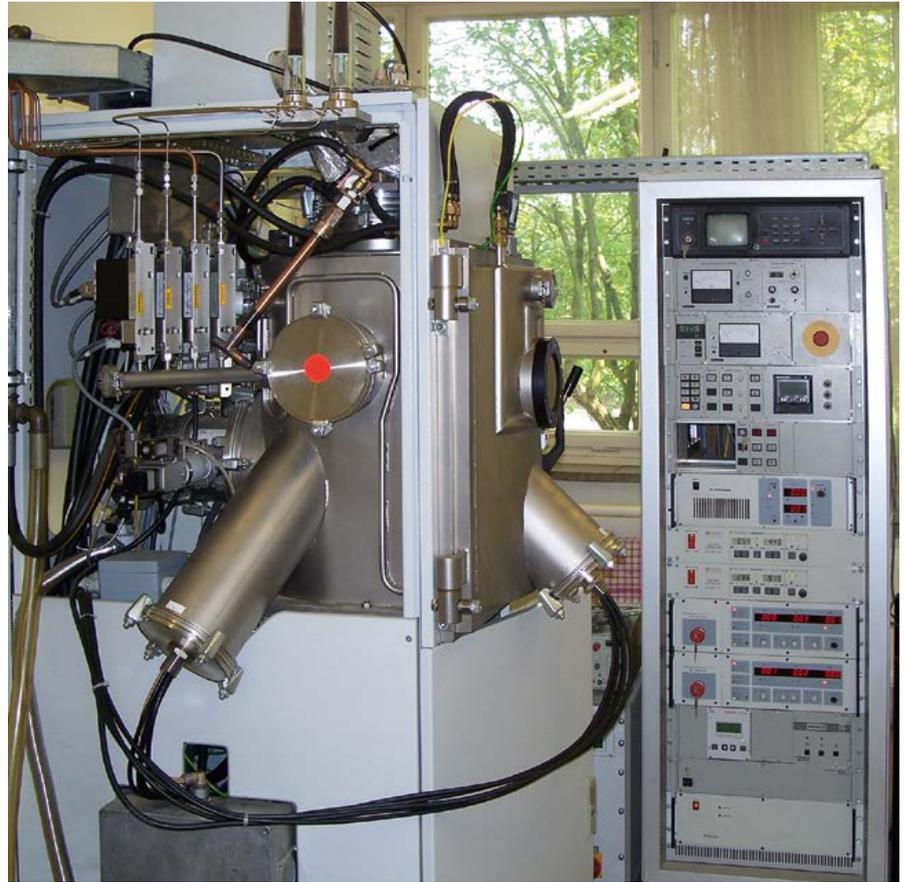
Abb. 28: Mehrquellensputteranlage PLS500 von Balzers (3 Sputterkathoden)
