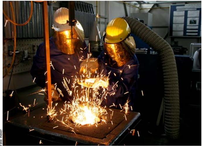
Abb. 15: Schmelzversuch am Mittelfrequenz-Induktionsofen
