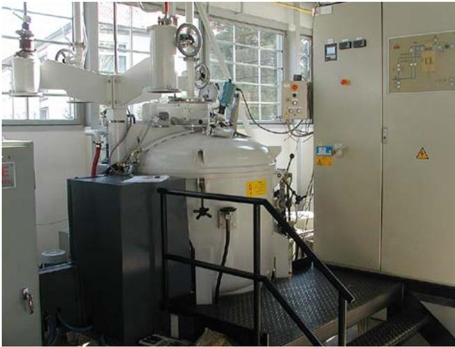
Abb. 14: Vakuum-Induktions-Schmelz- und Gießanlage
