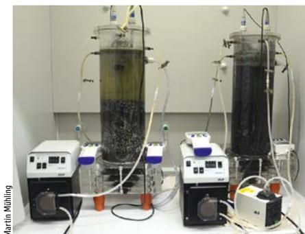
Abb. 18: Eine nachhaltige Methode zur Reinigung von saurem Kippengrundwasser aus dem Bergbau: Bioreaktoren zur mikrobiellen Sulfatreduktion am Institut für Biowissenschaften (Förderung: SIEMENS AG, SMWK)
