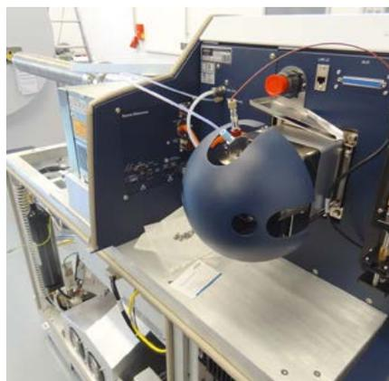
Abb. 14: Elektrospray-Ionenquelle des Bruker solarix FT-ICR Massenspektrometers
