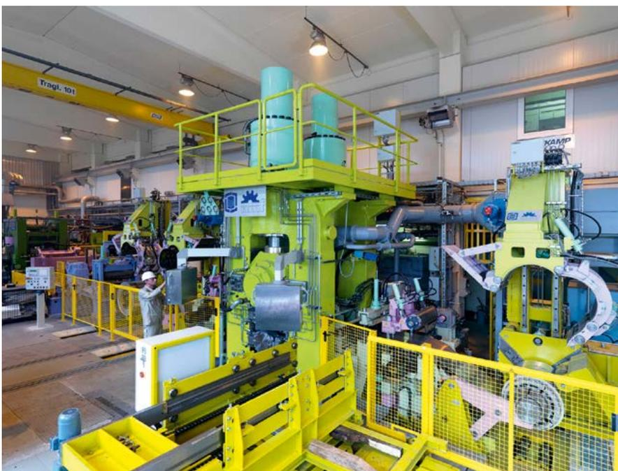
Abb. 25: Magnesiumgießwalz- und Bandwalzanlage
