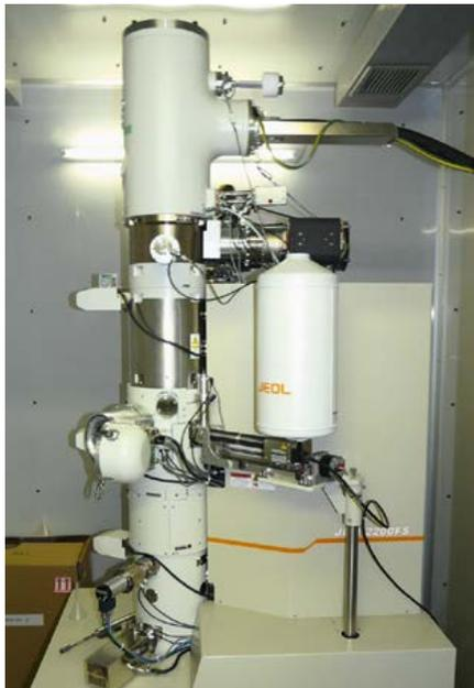
Abb. 29: Transmissionselektronenmikroskop JEOL JEM 2200FS (200 kV)
