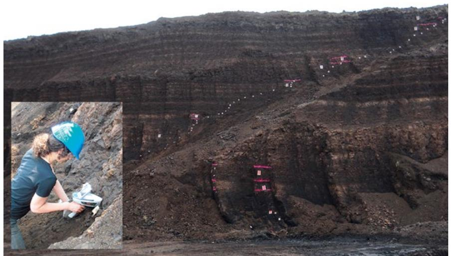
Abb. 3: Durchführung der punktgenauen RFA-Messung am Kohlestoß im Tagebau Schleenhain [8]
