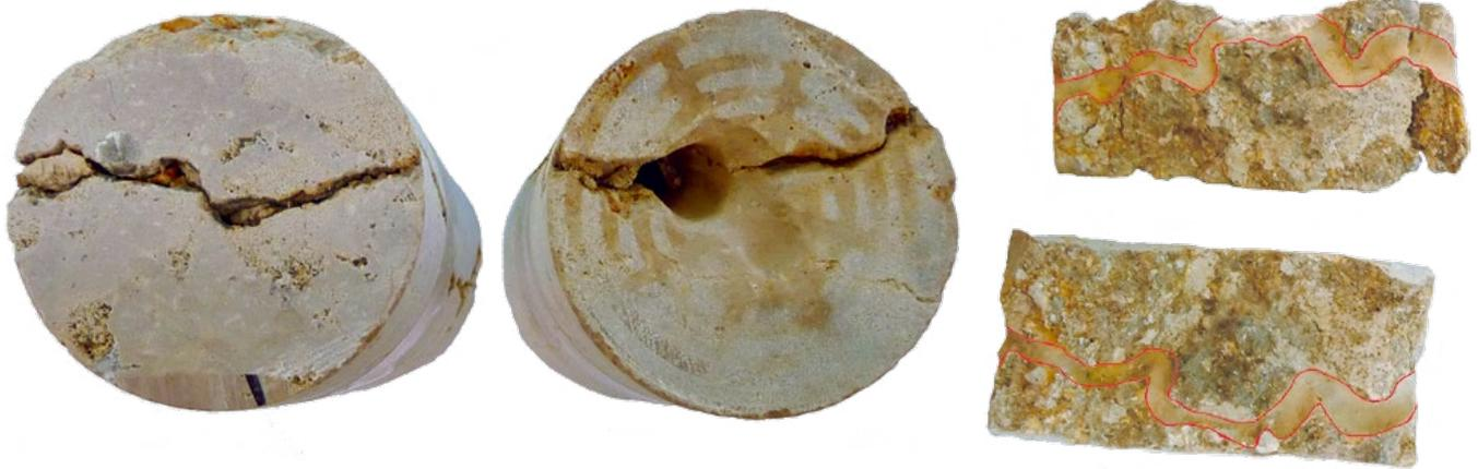
Abb. 11: Kern, durchströmt mit XC-Polymer-HCl-Mischung
