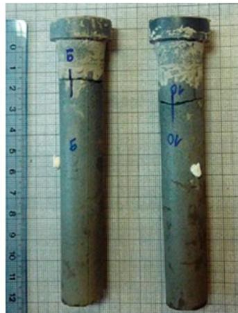
Abbildung 3: AZT-Testdüsen vor (links) und nach (rechts) Beaufschlagung mit Stahlschmelze [13]
