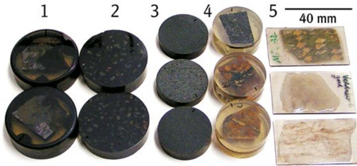
Abb. 2: Präparate für die automatisierte Mineralogie mit dem Rasterelektronenmikroskop: 1 – Klassische Erzschncliffe aus der Mineralogischen Sammlung der TU Bergakademie Freiberg, 2 – Epoxid-Blöcke mit groben Erzkörnern, 3 – Epoxid-Blöcke mit feinkörnigem Erz aus der Flotation, 4 – Gesteinsproben, z. T. mit Erz, 5 – Gesteins-Dünnschliffe
