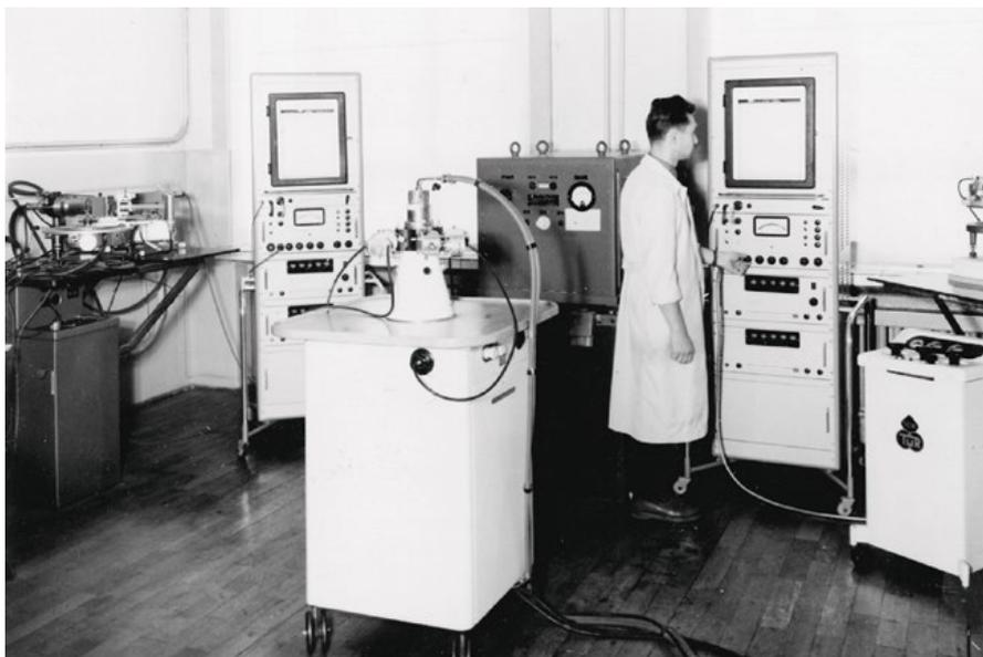
Abb. 2: Röntgenlabor des Instituts für Anorganische Chemie (1963) mit Zählrohrgoniometer nach Berthold (links), Generator M60 und Strahlmessplätzen VAM17
