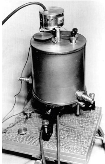
Abb. 1: Hochtemperatur-Filmkamera (Eigenbau Chemie, 1959)
