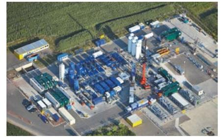
Abb. 3: Obertage-Bohrplatzausrüstungen für eine Frac-Behandlung, Bohrung neben dem roten Kran (Quelle: Exxonmobil)
