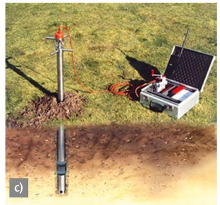
Abb. 3: (a) Geophone/Kabel/Geode/Laptop (Quelle: MASW); (b) Fallgewicht; (c) Sissy-Impulsquelle (Quelle: Geosym)
