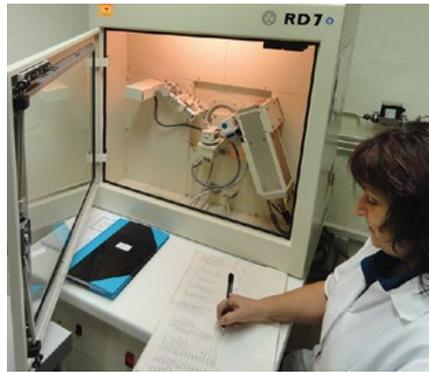
Abb. 7: Diffraktometer RD 7, der letzte Typ, der in der Präzisionsmechanik Freiberg entwickelt wurde (S. Mühlberg, Institut für Mineralogie 2012)
