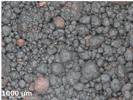
Abb. 8: Granulat aus Rohfeinkohle, zerkleinert und granuliert im Intensivmischer,  $t_Z = t_{Gr} = 150$  s,  $u_{z,W} = 37$  m s<sup>-1</sup>,  $\alpha_D = 0\%$
