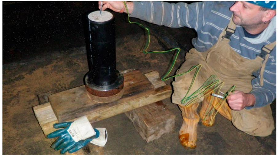
Abb. 1: Vorbereitung eines Schockwellensynthese-Experiments mit einer großen Ladung von 5,1 kg hochbrisantem Sprengstoff
