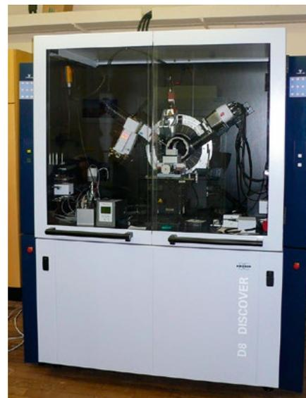
Abb. 3: Röntgendiffraktometer D8 Discover (Fa. Bruker AXS) im Institut für Anorganische Chemie, Arbeitsgruppe Salz- und Mineralchemie (2011)
