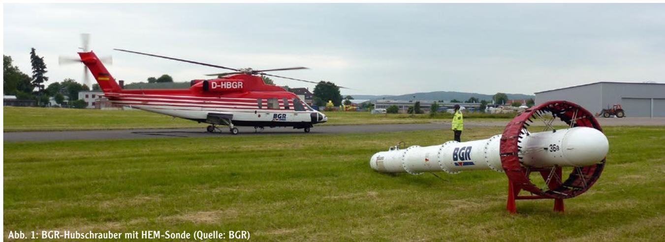
Abb. 1: BGR-Hubschrauber mit HEM-Sonde (Quelle: BGR)
