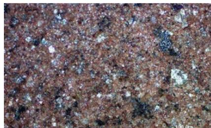
Abb. 3: Mikroskopische Aufnahme des Altenberger Haldenmaterials im Auflicht in 100-facher Vergrößerung. Neben Quarz sind verschiedene Glimmer (Hell- und Dunkelglimmer) enthalten. Die rötliche Farbe wird durch fein verteilten Hämatit hervorgerufen.
