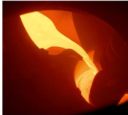
Abbildung 2: Stahlgussimulator mit ausgefahrener Schmelzeinheit und ausgefahrenen Kokillen (links), Blick in den Stahlgussimulator beim Umgießen der Schmelze in das Verteilergefäß (rechts)
