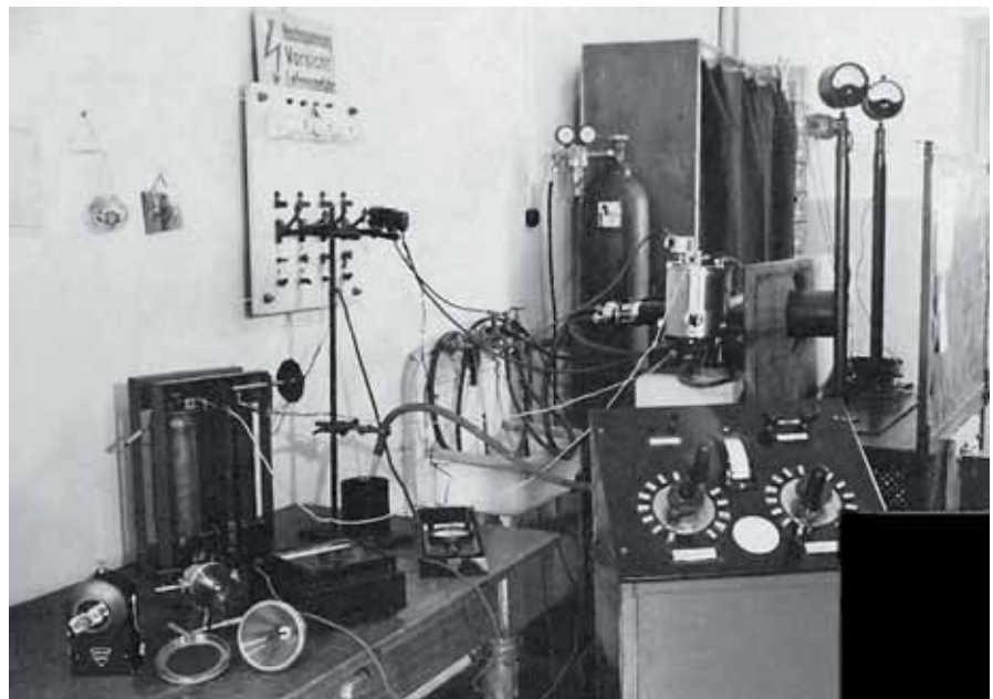
Abb. 3: Feinstrukturlabor des Instituts für Metallkunde (1952). Eigenbaugenerator mit Seemann-Hochtemperaturkammer und Reglerschen Kegelkammern (links)
