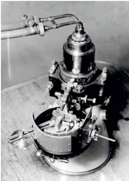
Abb. 7: Eigenbau einer Berg/Barrett-Kamera für Reflexionstopografien mit Generator M60 (1966, Konstruktion nach Wadewitz)
