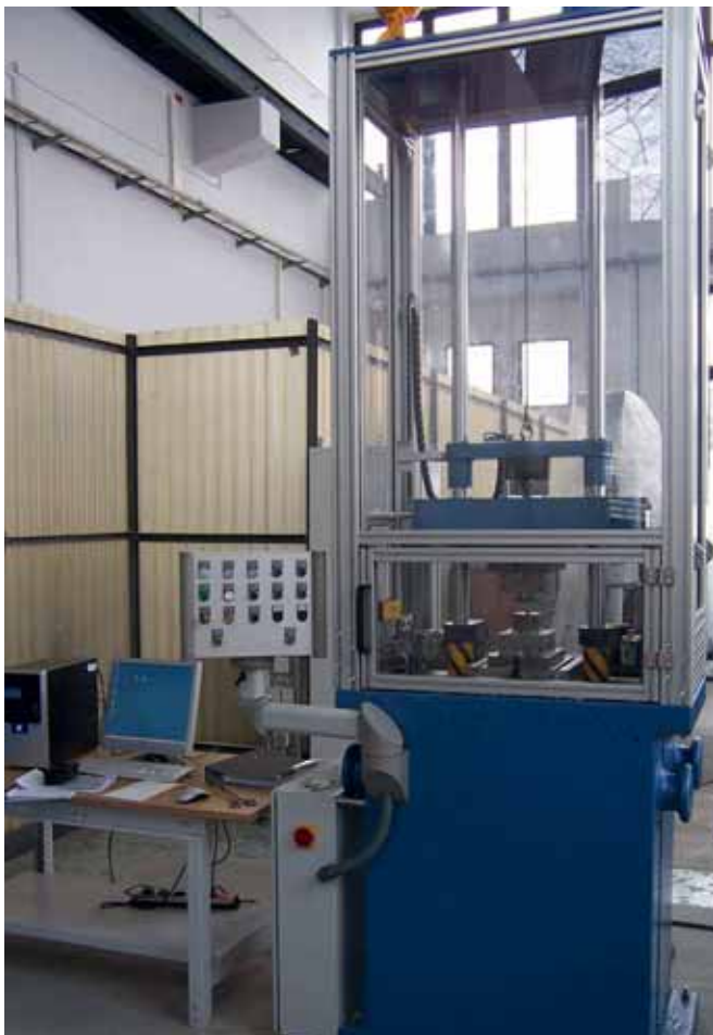
Abb. 2: Fallwerk am Institut für Werkstofftechnik
