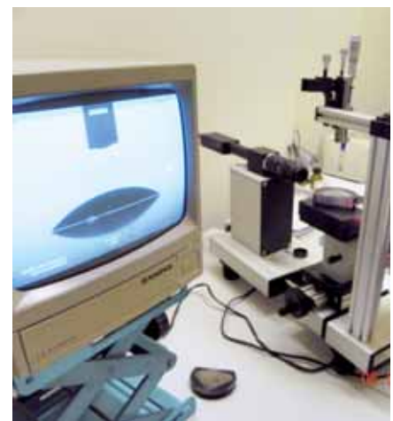
Abb. 7: Ein liegender Bitumentropfen, dessen seitliche Randwinkel vermessen werden
