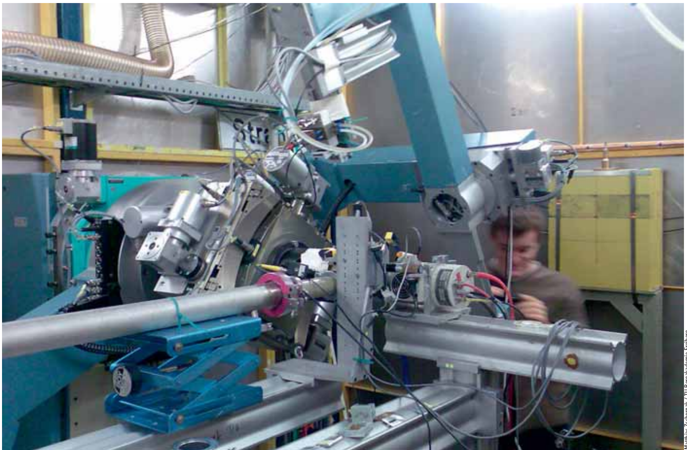
Abb. 1: Messaufbau für DAFS und AAS an der Beamline C des Speicherrings Doris III in Hamburg.
