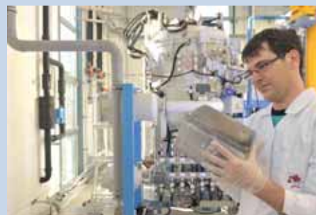
Fraunhofer THM im Gizef St. Niklas Schacht Freiberg. Doktorand Iven Kupka vor der Kristallisationsanlage mit einem Siliciumblock
