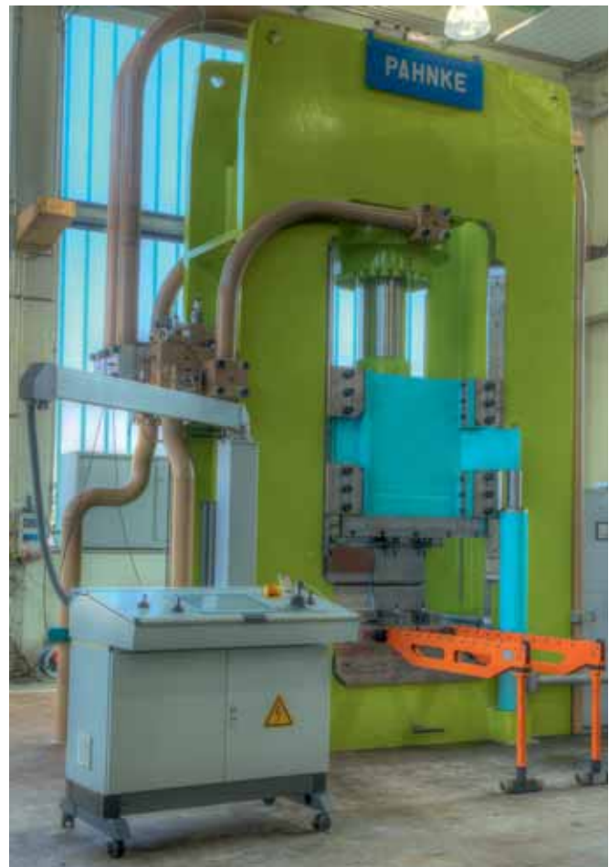
10 MN-Universalumformpresse vor der Erprobung am 10. Oktober 2011
