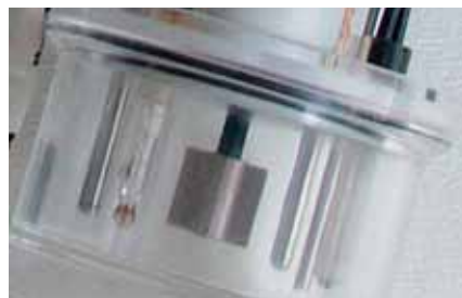
Abb. 5: oben: Sensorkalorimeter komplett, unten: Ausschnittsvergrößerung der Reaktionszelle mit Glaselektrode, Rührer und Kapillaren
