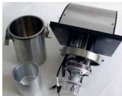
Abb. 6: Miniaturkalorimeter mit Sensorarray (links)
