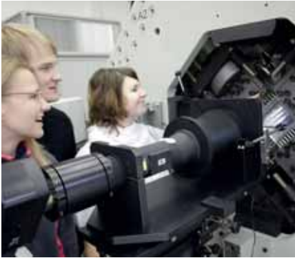
Abb. 4: Servohydraulisches Biaxial-Prüfsystem mit hochauflösender Zeilenscannerkamera am Institut für Werkstofftechnik
