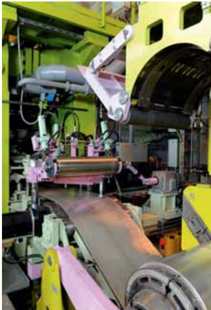
Abb. 2: Gießwalzanlage zur Herstellung von Mg-Flachprodukten
