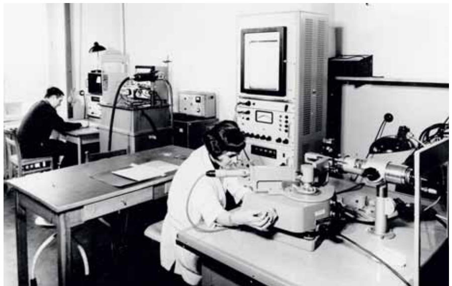
Abb. 5: Eines der Röntgenlaboratorien im Institut für Metallkunde (1964). Ch. Krause mit Diffraktometer HZG1, H. Oettel mit Zählrohrgoniometer nach Berthold
