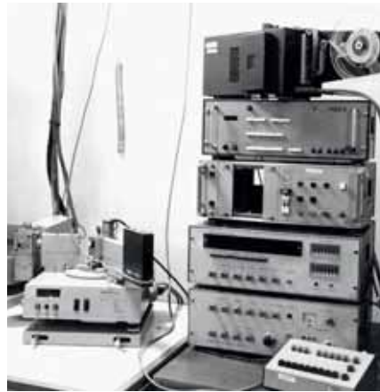
Abb. 8: Diffraktometer HZG3 mit Detektorversorgung, Zählinheit, Lochertreiber, Diffraktometersteuerung und Lochstreifenstanze (SMWT 1978)
