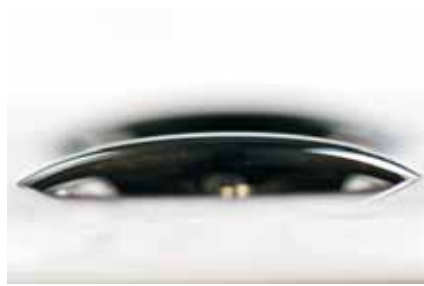
Abb. 7: Ein liegender Bitumentropfen, dessen seitliche Randwinkel vermessen werden
