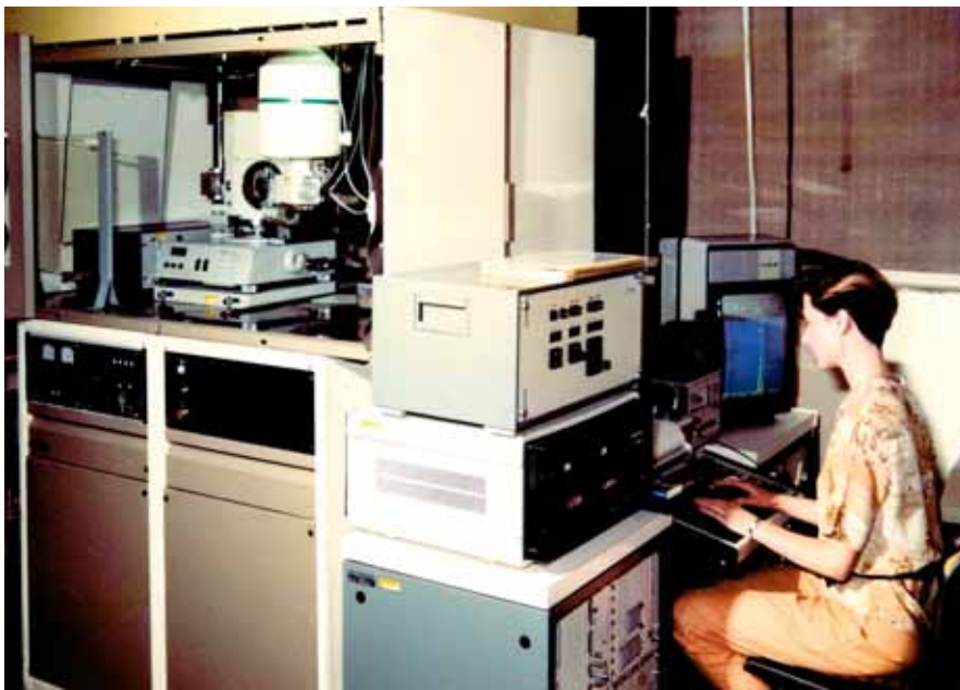
Abb. 9: R. Knebel am Diffraktometer HZG3 mit energiedispersivem Detektor (SMWT, 1990)
