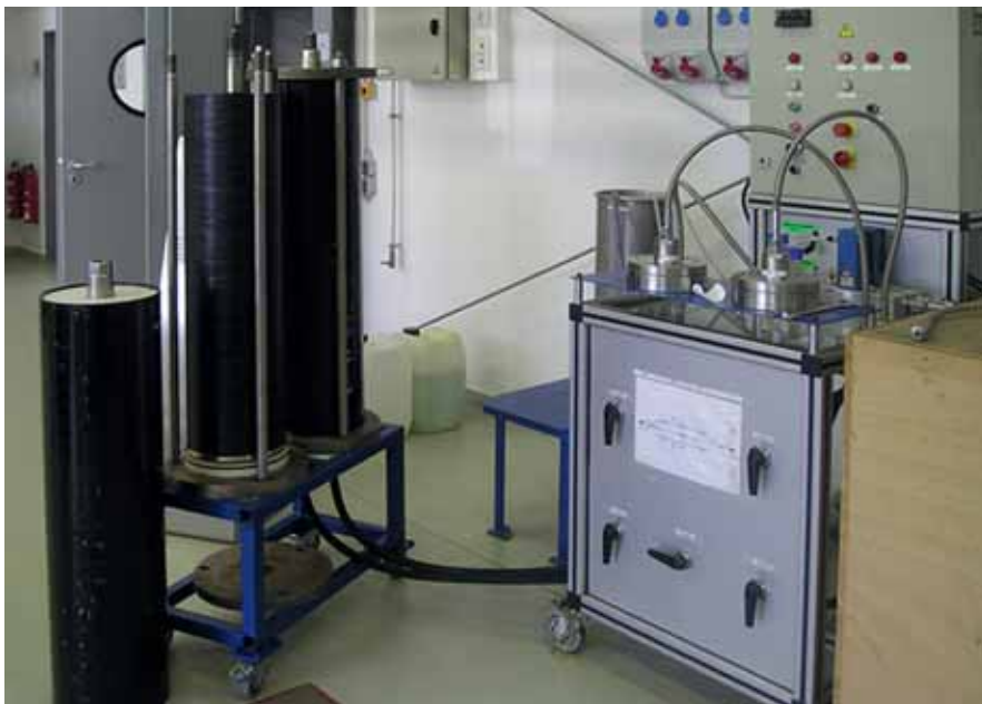
Abb. 4: Versuchsaufbau mit kleinen 63-cm 2 -Testzellen (rechts) und Plattenmodulen mit jeweils 7 m 2 Membranfläche (links) [8]
