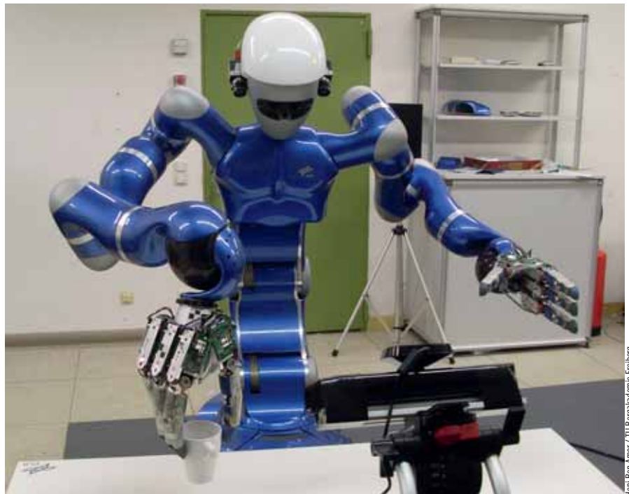
Justin – der Roboter des Deutschen Zentrums für Luft- und Raumfahrt in Oberpfaffenhofen. Dank der Freiburger Forschungen kann Justin Objekte sicher greifen und manipulieren.
