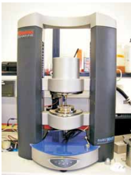
Abb. 6: Dynamisches Scherrheometer für die Bestimmung der temperaturabhängigen Viskosität von Bitumen
