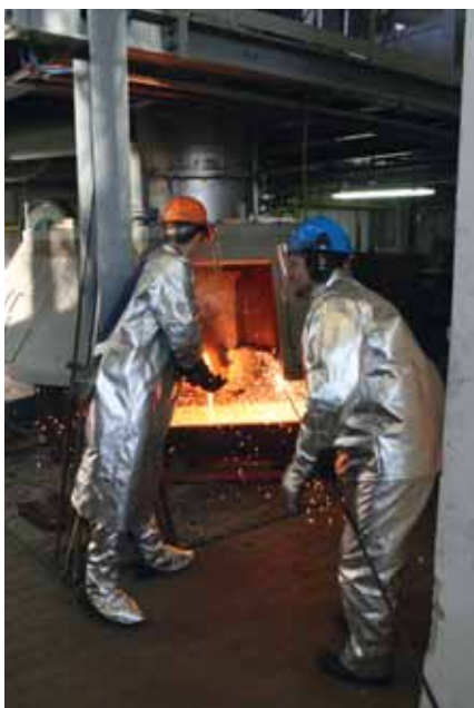
Abb. 2: Abstich am ISA-Smelt-Ofen des Instituts für NE-Metallurgie und Reinstoffe
