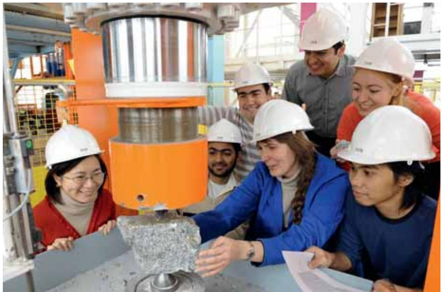
Sabine Schreiber, wissenschaftliche Mitarbeiterin am Institut für Aufbereitungsmaschinen, führt mit internationalen Studierenden einen Punktlastversuch an einem Granit durch. Mit dem Versuch kann die Druckfestigkeit des Gesteins bestimmt werden. Foto: Detlev Müller
