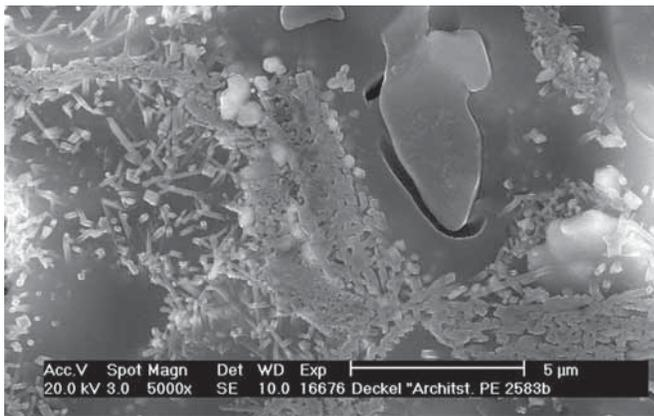
Abb. 7: Typisches Gefüge eines Böttgersteinzeugs (18. Jh.); Vergr. 5000 ×
