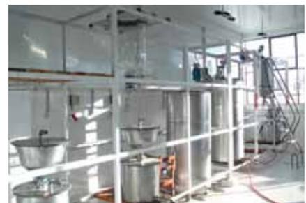
Abb. 10: Blick in das chemische Technikum der UATF Potosi zur Herstellung von Lithiumcarbonat aus Salzlösung des Salars de Uyuni (August 2010)
