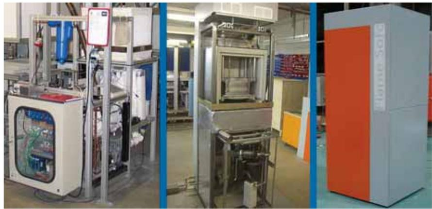
Abb. 3: Erster Laboraufbau (links), zweiter Prototyp (Mitte) und „FlameBox“ (rechts) für die Evaluierungsphase im Langzeitbetrieb
