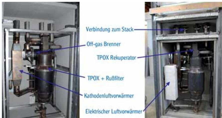
Abb. 4: Die FlameSOFC HotBox. Der hintere schmalere Bereich beherbergt in einer dritten Zone alle „kalten“ Peripheriekomponenten, wie Lüfter, Steuerung, Stromwandler, Sensoren etc.
