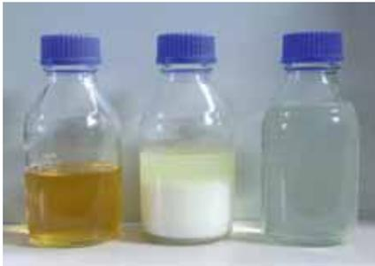
Abb. 6: Jatrophaöl (links) und Hydrierprodukte (Reaktionstemperatur 300 °C Mitte, 360 °C rechts)
