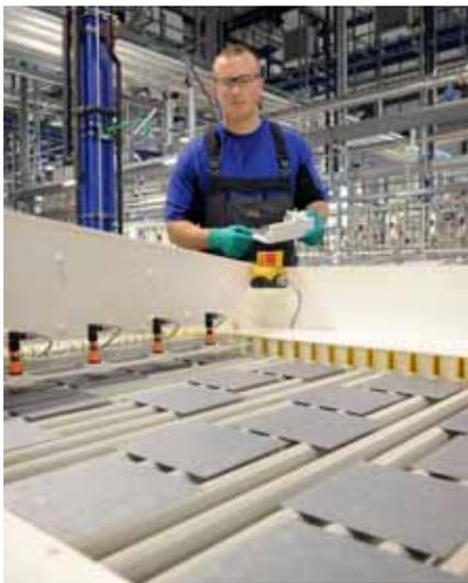
Die letzte Stufe der Waferfertigung ist die Endreinigung und Qualitätskontrolle
