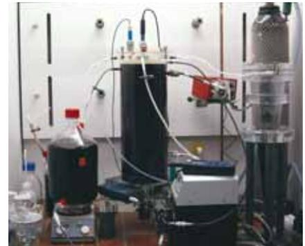
Abb. 3: Reaktor zur mikrobiellen Sulfatreduktion, links kurz nach dem Start, rechts nach Beginn der Reduktion des Sulfats zu schwarzen Sulfiden
