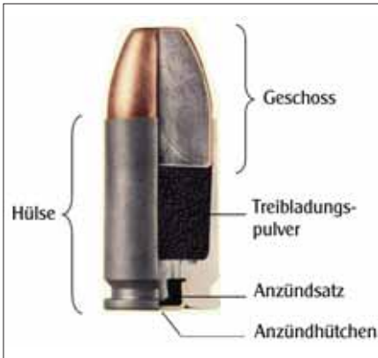
Abb. 1: Aufbau einer Patrone für Pistole
