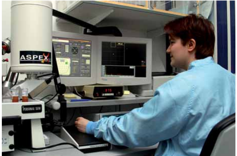
Abb. 2: Frau Dr. Sylvia Steffen analysiert am Rasterelektronenmikroskop im BKA Wiesbaden Schmauchspuren von Probeschüssen, Foto: BKA Wiesbaden
