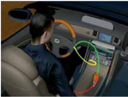
Abbildung 5: Aufgezeichnete Aktionssequenzen können zur Animation unterschiedlicher virtueller Menschmodelle eingesetzt werden. Auch bei Modifikationen des virtuellen Prototyps, z.B. wurde im Beispiel die Schaltkonsole versetzt, können gültige Animationen erzeugt werden.
