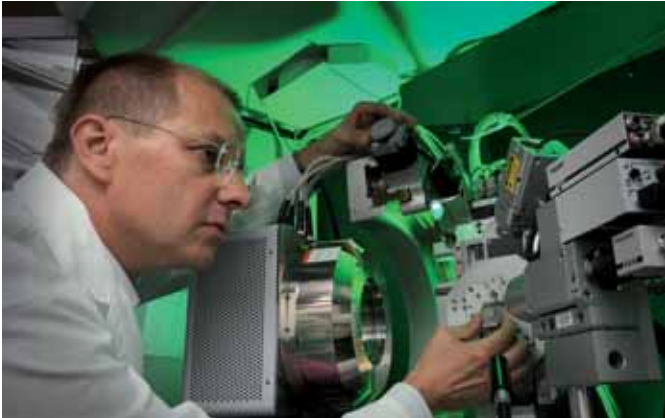
Prof. Hans Jürgen Seifert untersucht am Röntgendiffraktometer eine lithiumhaltige Legierung, die in Lithium-Ionen-Batterien zum Einsatz kommt. Fotos (2): Detlev Müller
