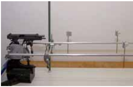
Abb. 4. Versuchsaufbau der Schussversuche. Einspannvorrichtung mit Waffe Star 30M „Schmouch-Fänger“, Foto: BKA Wiesbaden
