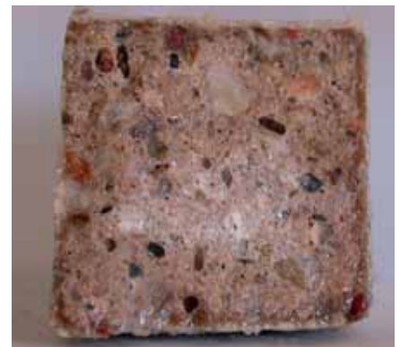
Abb. 3: \text{MgO} -Beton, hergestellt aus \text{MgO} und konzentrierter \text{MgCl}_2 -Lösung mit silikatischem Zuschlagstoff zum Einsatz als Dammbaumaterial im Kalisalz (optisch nicht vom normalen Beton zu unterscheiden)
