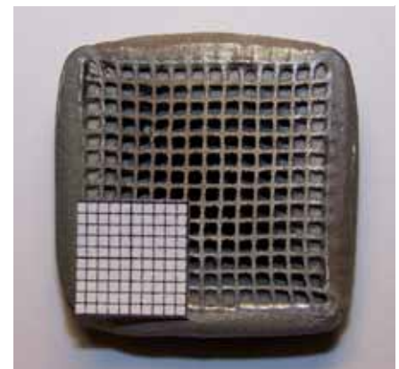
Bild 5: Draufsicht Wabenkörper Versatz Z10 nach dem Druckversuch
