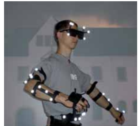
Abbildung 2: Motion Capture ermöglicht die Animation virtueller Menschmodelle durch direkte Übertragung der aufgezeichneten Bewegungen. Zur Animation von Interaktionen mit Umgebungsobjekten genügt ein reines Motion Capture jedoch nicht, da die aufgenommenen Bewegungsabläufe auf die virtuellen Menschmodelle entsprechend ihrer jeweiligen Größe angepasst werden müssen. Das neu entwickelte Action Capture Verfahren leistet derartige Anpassungen an neue Zielsituationen.
