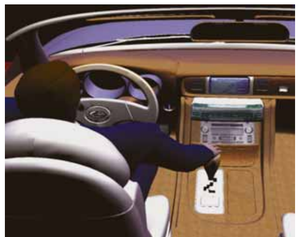
Abbildung 1: Animationsgenerierung mit dem Action Capture Verfahren. Links: Die Bedienung eines virtuellen Prototyps wird in virtueller Realität durchgespielt. Rechts: Die Bedienungssequenz wird von einem virtuellen Menschmodell reproduziert.
