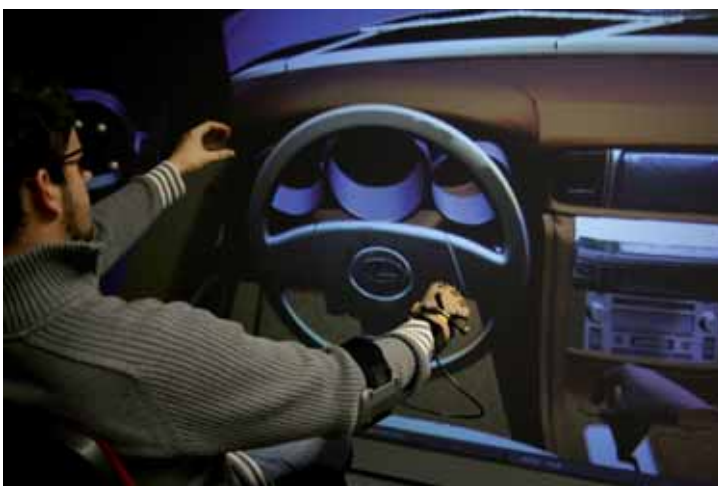
Abbildung 1: Animationsgenerierung mit dem Action Capture Verfahren. Links: Die Bedienung eines virtuellen Prototyps wird in virtueller Realität durchgespielt. Rechts: Die Bedienungssequenz wird von einem virtuellen Menschmodell reproduziert.
