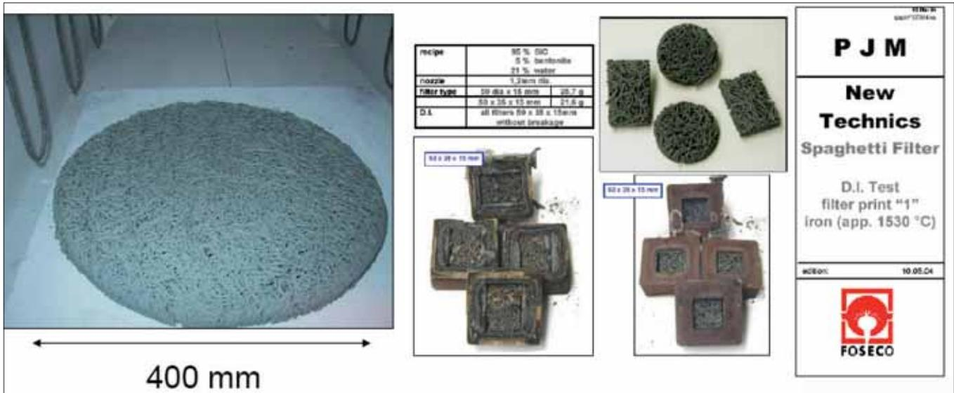
Abb. 5: 400 mm-Spaghettifilter (links) und Impinchment-Test an  $50 \times 50 \times 15 \text{ mm}^3$ -Proben (rechts)
