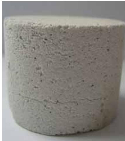
Abb. 8: Gepresster Zylinder auf Blähperlitstaubbasis
