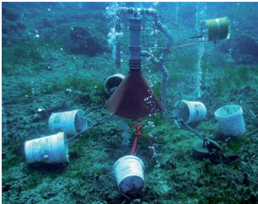
Eigens entwickelte Messapparatur zur Gasvolumenstrommessung
