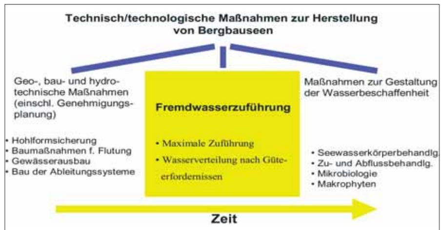
Abb. 3.1: Ablauf der Sanierung in Anlehnung an [3.2]
