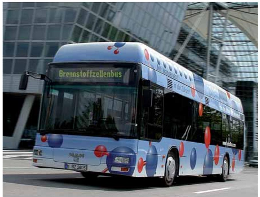
Bild 7: Brennstoffzellenbus auf Wasserstoffbasis
