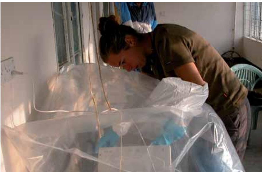
Abb. 4a: Verpacken der Sedimentproben unter Sauerstoffabschluss
