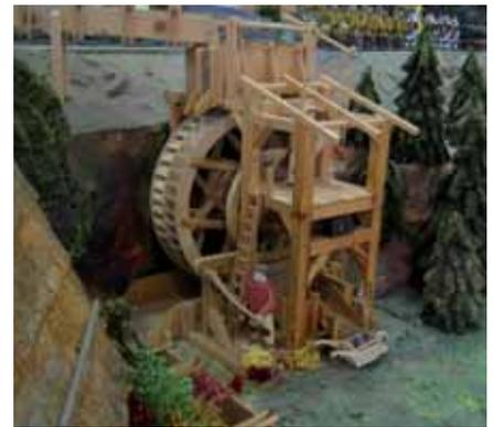
Bild 2: Schachtförderung mit einem Kehrrad
