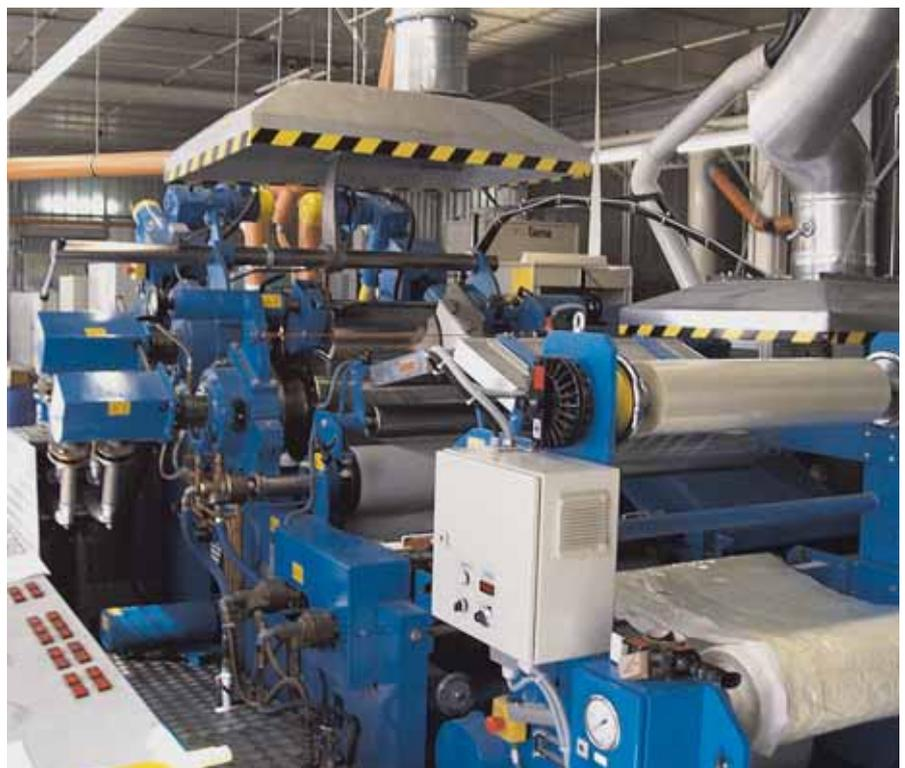
Schmelzwalzenkalandrier für thermoplastische Beschichtung unterschiedlicher Substrate. Fotos (6): FILK
