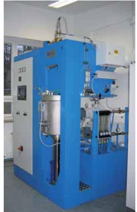
Bild der Spark Plasma Sintering Anlage
