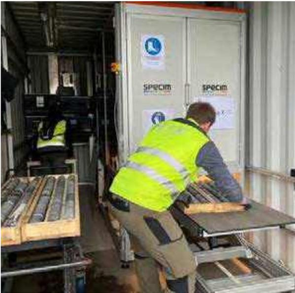
Abb. 2: Bohrkernscanner für die hyperspektrale Bildgebung. (Quelle: HZDR/HIF)
