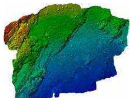
Abb. 12: Orthofoto und digitales Höhenmodell des Knollen-Kalkrotalgen-Feldes in Babino erzeugt mittels Photogrammetrie
