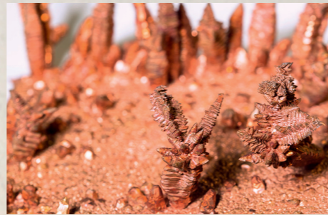
Elektrolytisch abgeschiedenes Kupfer
