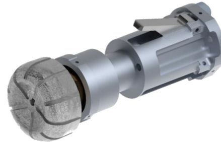
Richtbohrtechnikprototyp im Kleinstmaßstab.
