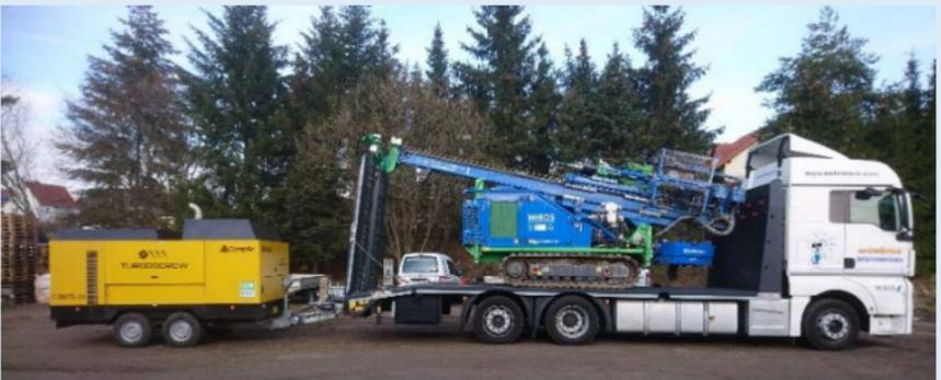
*WiBOS auf einem Tieflader mit angehängtem Kompressor*
