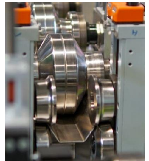
Hutprofil am Austritt der letzten Umformstufe
