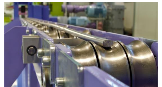
Drahtgießwalzanlage und Gießwalzdraht
