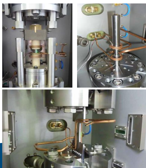
Zylindrische, Zug- und Flachprobeneinheiten
