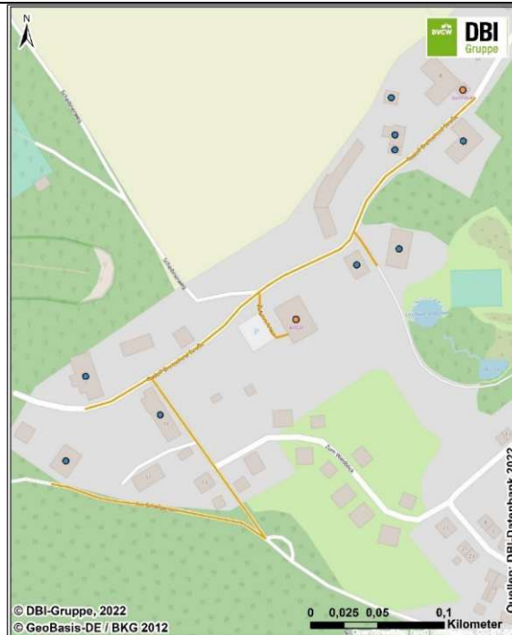
Mögliches Wärmenetz am Standort Fleischerberg Hohndorf blau: Wohngebäude; orange: Gewerbe; gelb: Kommune
