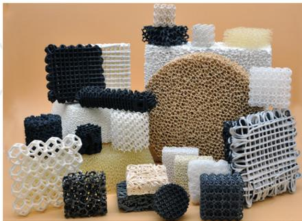
Foto: Filterbauteile und -strukturen für die Metallschmelzefiltration, Projektbereich A.
