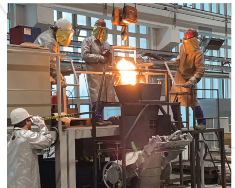
Foto: Impingementtest am Gießerei-Institut zur Eignungsprüfung neu entwickelter Metallschmelzefilter.
