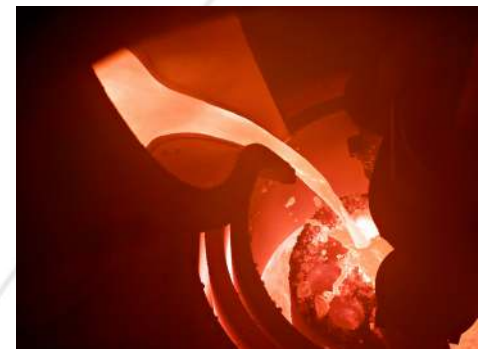
Foto: Abguss Stahlschmelze im Stahlgussimulator über einen Schaumkeramikfilter auf Basis von Aluminiumoxid in einen feuerfesten Tiegel bei 1650 °C.
