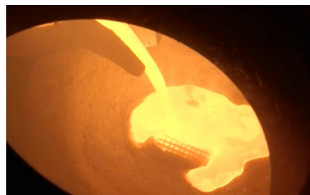
Foto: Test von Filterstrukturen im Stahlgussimulator.
