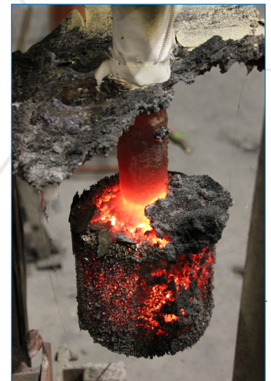
Abb. 2: Kohlenstoffgebundene Aluminiumoxid-Filter nach Einsatz im industriellen Strangguss.
