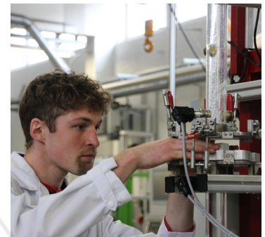
Foto: Fabian Heuzeroth beim Einsetzen der im TP A02 hergestellten Filter für Testversuche im Filtrationsstand.
