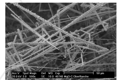
Abb. 3: Sekundäres MgO auf Probekörper nach Kontakt mit der Stahlschmelze.
