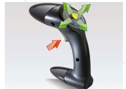
Abb. 3: Flystick zum Tracking von Position und Orientierung in 3 Dimensionen und zur Navigation sowie dem Emittieren von Tracer-Partikeln und Stromlinien im Datensatz.
