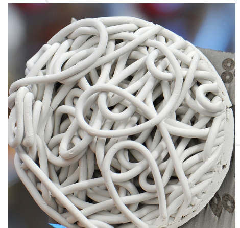
Abbildung: Spaghetti-Keramik als Ausgangspunkt für Filtermakrostrukturen
