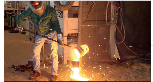
Gießversuch mit Stahlschmelze (1600° C) durch Herrn Schlesinger, Mitarbeiter des Gießerei-Institutes
