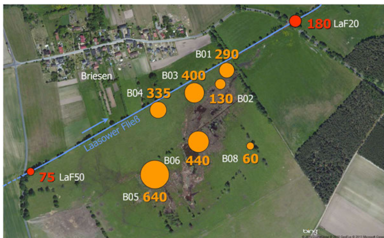
Abb. 6: Eisenkonzentrationen im Grundwasser eines pleistozänen Grundwasserleiters unmittelbar unter einem mittelgründigen Niedermoor bei Briesen, Luftbild: Microsoft Bing Maps
