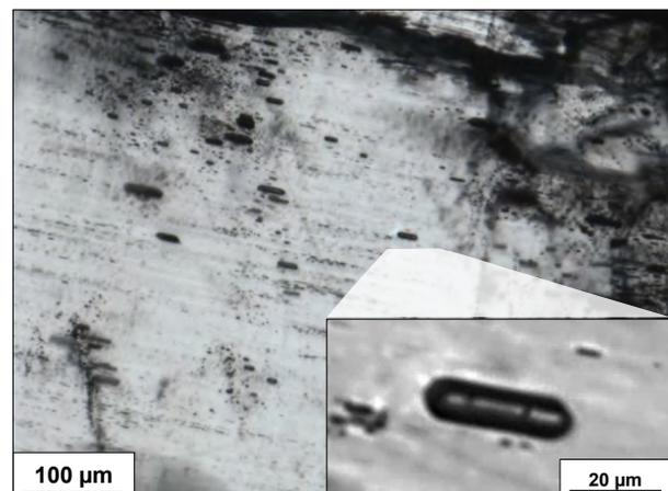
**Links:** Zweiphasige Flüssigkeitseinschlüsse in Pyrit (Foto: Jim Reynolds) aufgenommen mit IR-Analogkamera Dage LSG-70. **Rechts:** Zweiphasige Flüssigkeitseinschlüsse in Antimonit aufgenommen mit IR-Digitalkamera Qimaging Retiga 2000R
